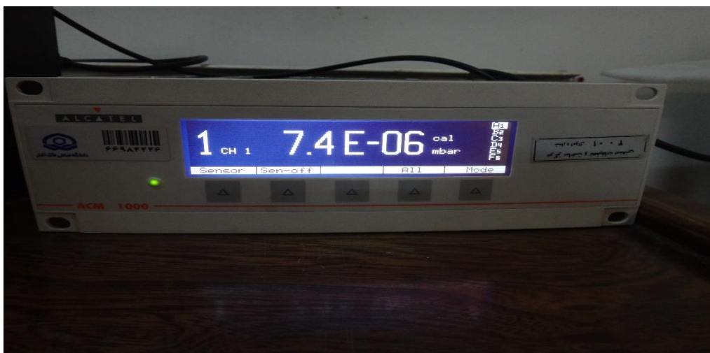
شکل ۵-۶ فشار خلأ به دست آمده توسط پمپ توربو
