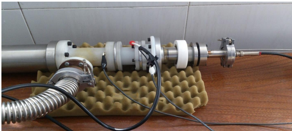
شکل ۵-۱۳ اتصالات الکترونیکی به مجموعه سیستم استخراج چشمه یونی پنینگ، (الف) سوسماری سفید اتصال الکتریکی الکتروستخراج، (ب) سوسماری قرمز اتصال الکتریکی الکتروستخراج، (ج) سوسماری مشکی اتصال الکتریکی الکتروستخراج
