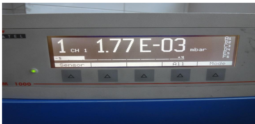
شکل ۵-۷ فشار خلأ به دست آمده توسط پمپ روتاری
