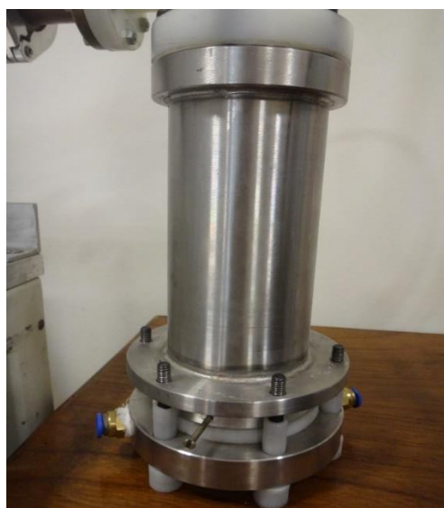
شکل ۴-۱۱ فنجان فارادی برای اندازه‌گیری جریان باریکه چشمه یونی
