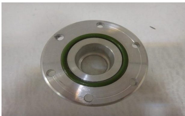
شکل ۵-۳ نحوه قرارگیری اورینگ در داخل شیار الکتروستخراج که به عنوان مثال در این شکل، اورینگ در شیار الکتروستجابدهنده نشان داده شده است.
