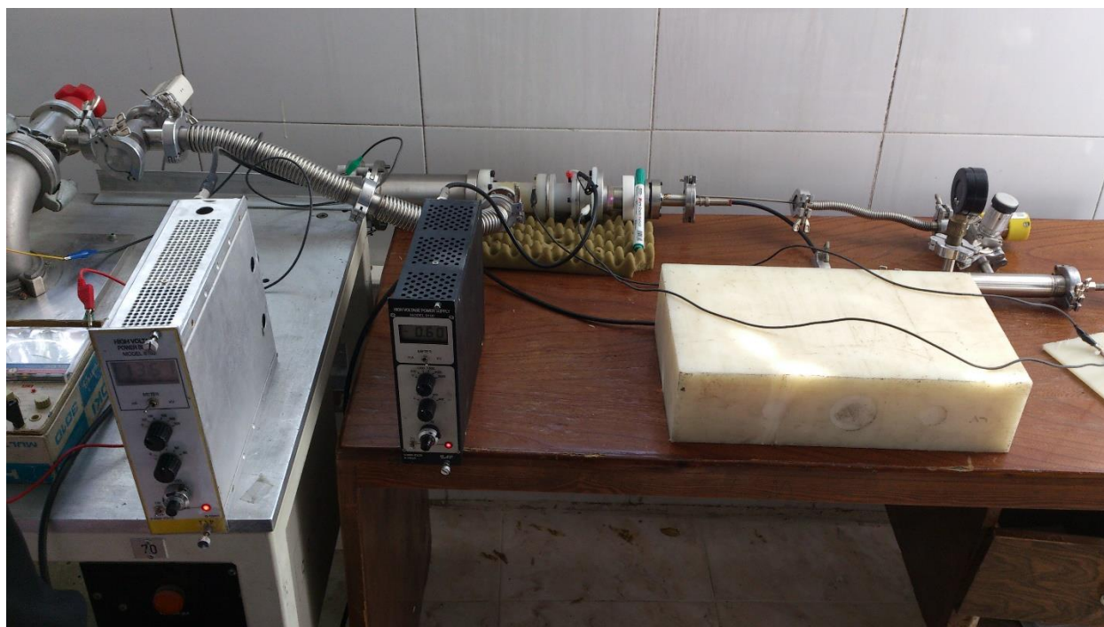
شکل ۵-۵ شکل نهایی قطعات سرهم شده مجموعه اتاقک یونش و سیستم استخراج و اتصالات مربوط به محفظه تزریق گاز
