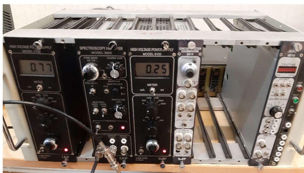
شکل ۶-۱۴ مجموعه تقویت کننده و منبع های ولتاژ بالا برای آنود و ماریچ
