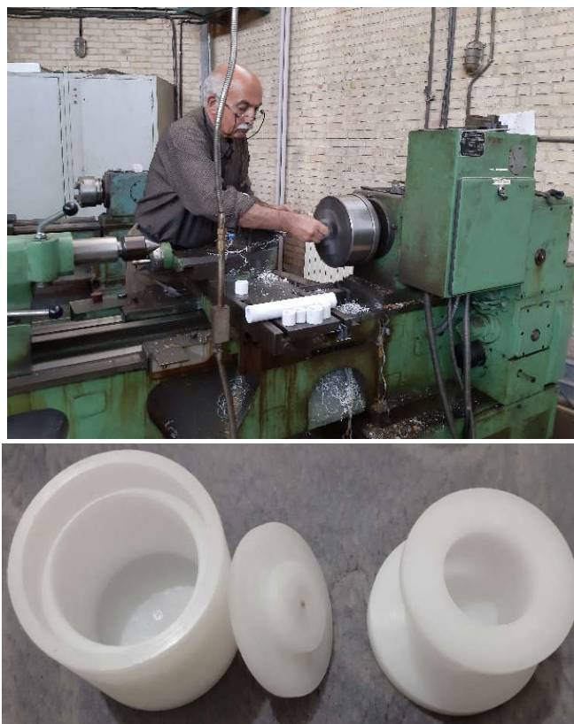
شکل ۱-۶ دستگاه تراش آزمایشگاه ماشین ابزار دانشگاه صنعتی شاهرود و طراحی میکرودزیمر اولیه
