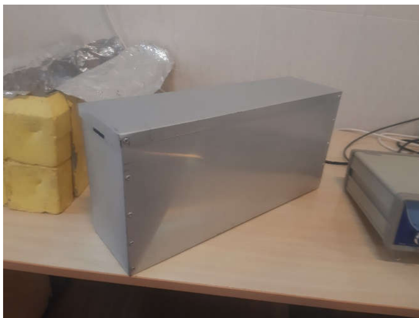
شکل ۶-۸ محفظه آلومینیومی ساخته شده برای این پژوهش از صفحات تخت آلومینیوم
