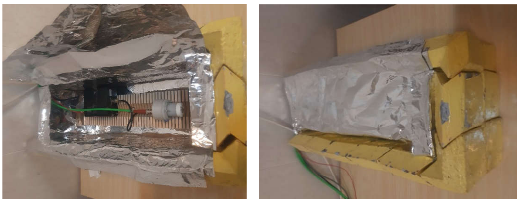
شکل ۶-۷ فویل آلومینیومی جهت محفظه رسانا به منظور جلوگیری از ورود نویز به داخل سیستم
