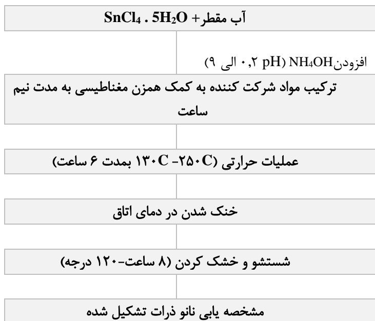
شکل ۲-۵: مراحل ساخت نانوذرات دی اکسید قلع به روش هیدروترمال
