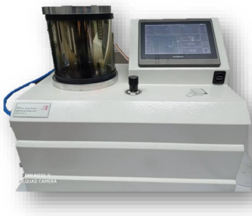
شکل ۴-۲۱: حسگر TEDO ، در مقایسه با ابعاد انگشت دست (ب) دستگاه اسپاترینگ مورد استفاده در چاپ الکتروود
