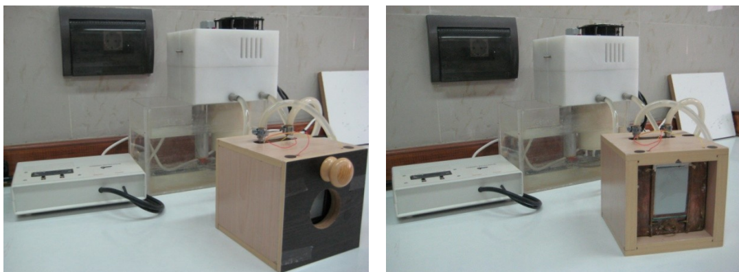
شکل ۵-۹ سیستم انتقال حرارت برای بررسی تأثیر دما بر عملکرد قطعه ACPEL.
