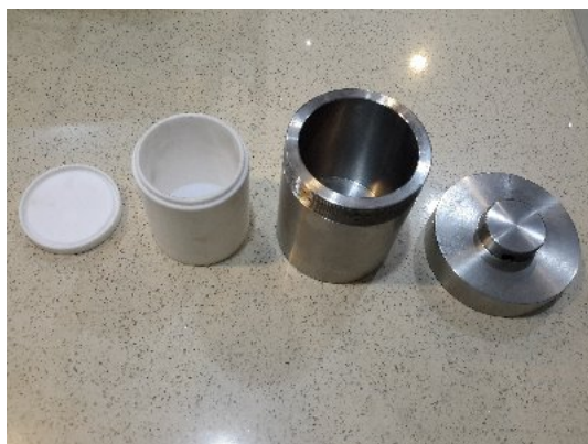
شکل ۱.۴: محفظه استیل اتوکلاو هیدروترمال به همراه محفظه تفلنی درون آن
