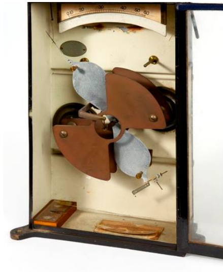
شکل ۲-۵: ولتمتر ساخته شده توسط کلونین [۲۸].
