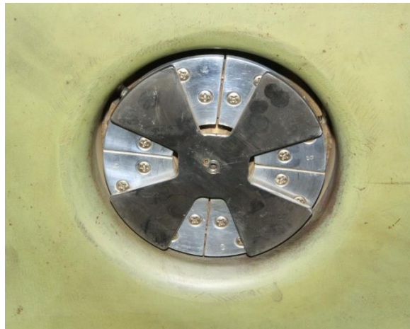
شکل ۳-۳: GVM با استاتور ۸ قطاعی استفاده شده در شتاب‌دهنده وان‌دوگراف
