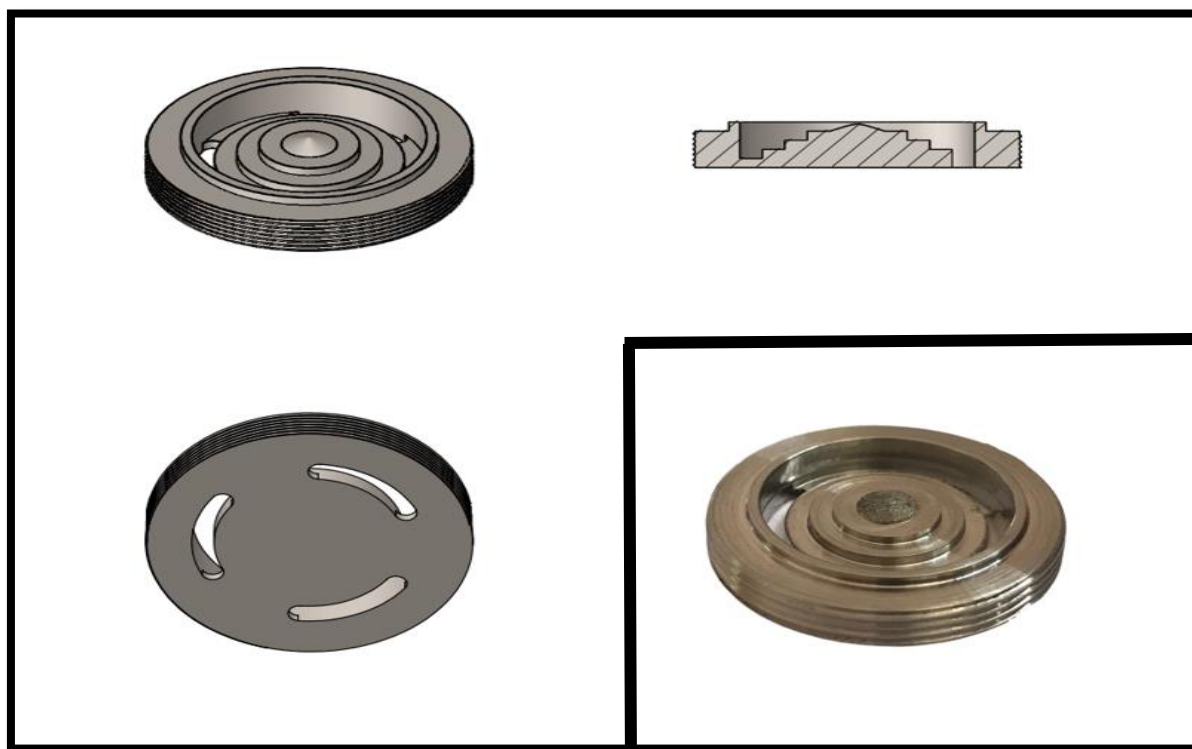
شکل ۳-۴ طرح کاتد سه پله‌ای و مخروطی و نمونه ساخته شده
