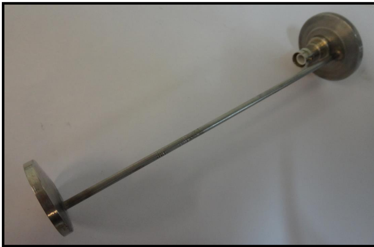
شکل ۴-۱۲ لوله تزریق گاز و فید ترو
