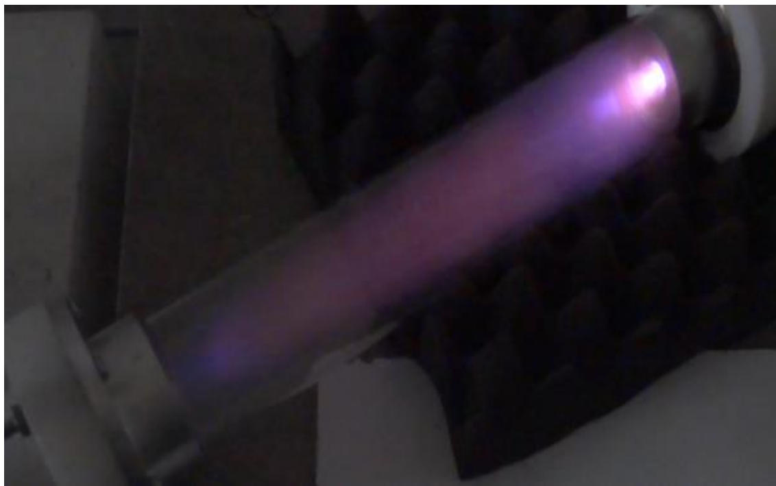
شکل ۵-۶ لحظه روشن شدن چشمه یونی پنینگ
