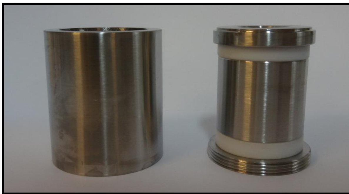
شکل ۴-۱۹ قطعات اصلی اتاقک یونش سرهم شده (سمت راست) پوسته نگهدارنده اتاقک یونش (سمت چپ)
