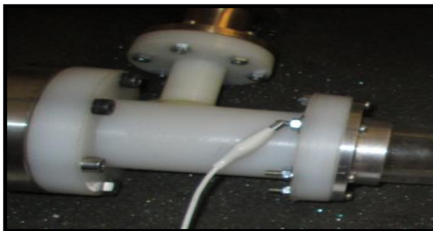
شکل ۴-۱۶ قطعه تفلونی T شکل متصل شده به فنجان فارادی و اتصالات پمپ خلا
