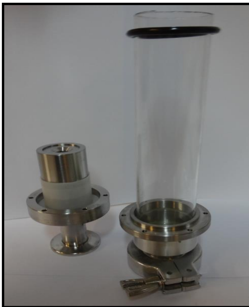
شکل ۳-۵ اتاقک یونش قرار گرفته در فلنج پایین با استفاده از یک قطعه تفلونی (سمت چپ) اورینگ قرار گرفته در لوله شیشه‌ای پیرکس و فلنج بالا (سمت راست)
