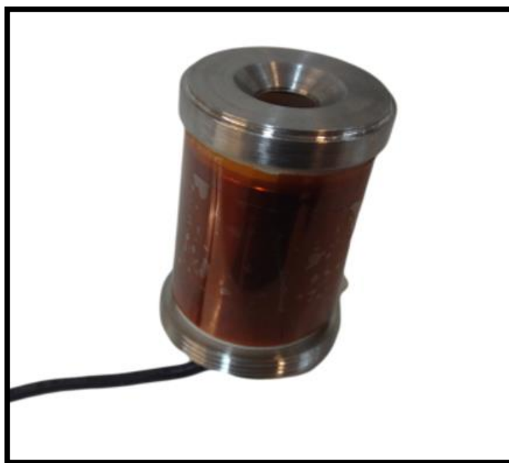
شکل ۵-۲ اتاقک یونش چشمه یونی پنینگ سرهم شده
