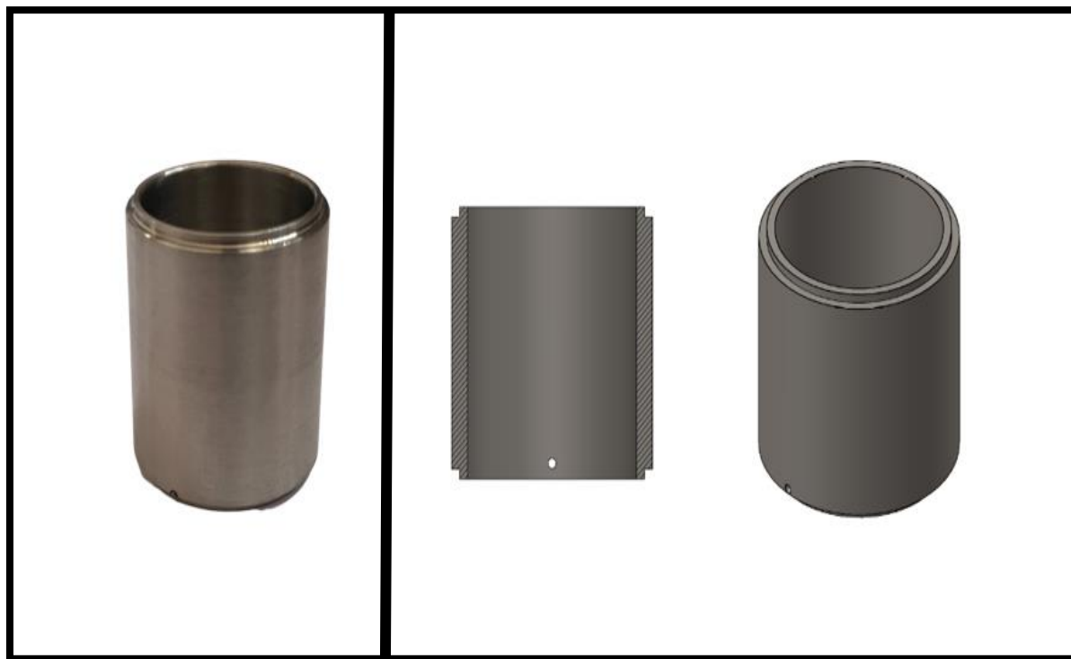
شکل ۴-۵ طرح آند (سمت راست) و نمونه ساخته شده (سمت چپ)
