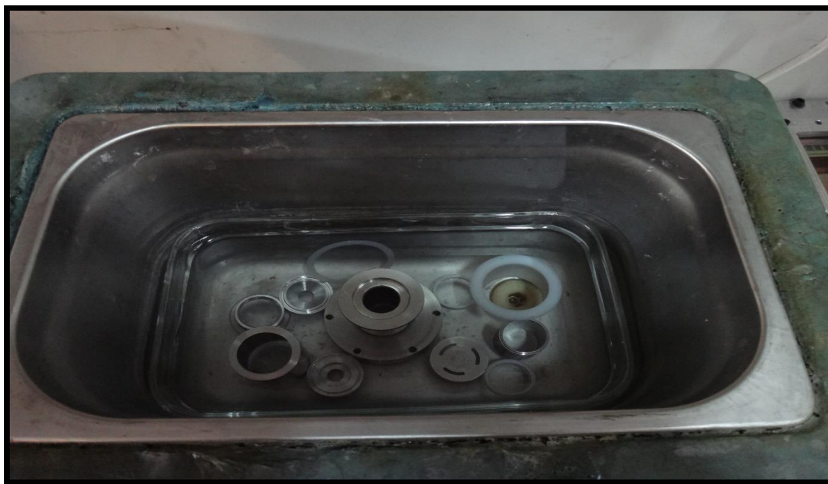
شکل ۵-۱ قطعات چشمه یونی پنینگ قرار گرفته در دستگاه التراسونیک
