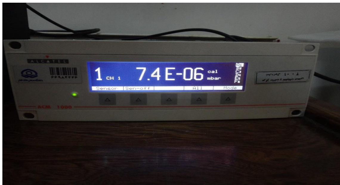
شکل ۵-۵ فشار خلا مجموعه چشمه یونی پنینگ قرائت شده
