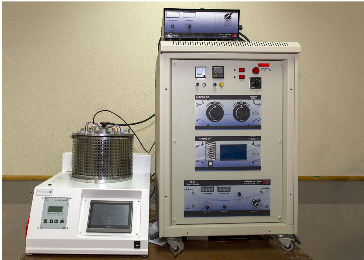
شکل ۳-۱: نمای کلی سیستم کندوپاش مغناطیسی جریان مستقیم و فرکانس رادیویی همزمان واقع در دانشگاه صنعتی شاهرود
