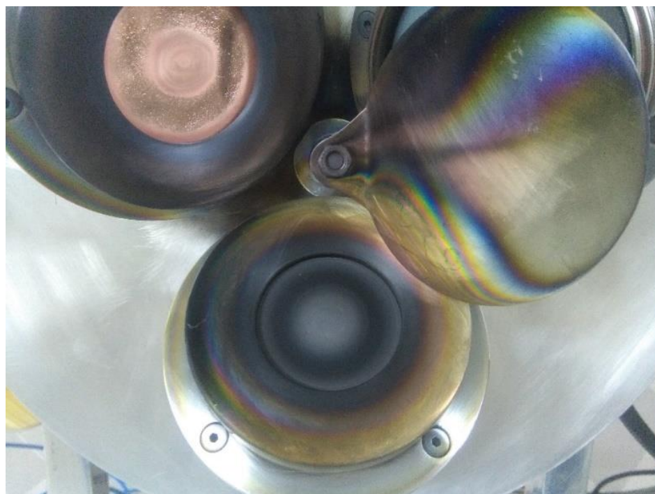
شکل ۳-۷: تصویری از ماده‌های هدف و نگهدارنده آن در سیستم کندوپاشی
