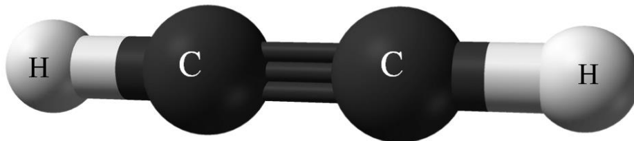
شکل ۶-۱: ساختار مولکولی اتم استیلن
