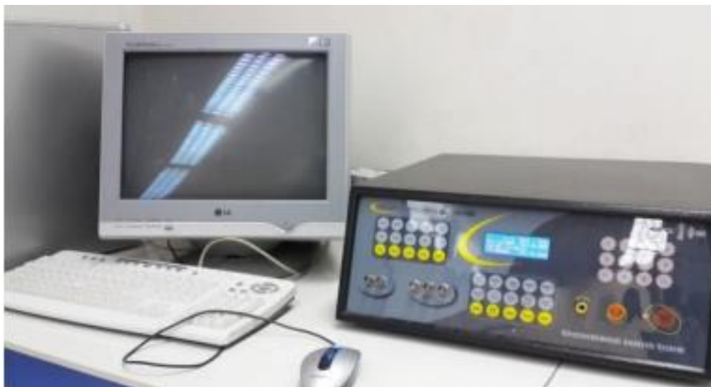
شکل ۹-۲: دستگاه پتانسیومتر آنالیز الکتروشیمیایی مدل PGS2065
