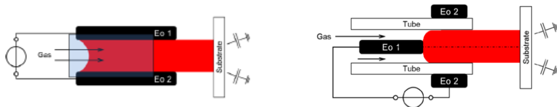
شکل ۲-۱۰. ایجاد یک میدان الکتریکی عمود بر شار گاز [۳]
