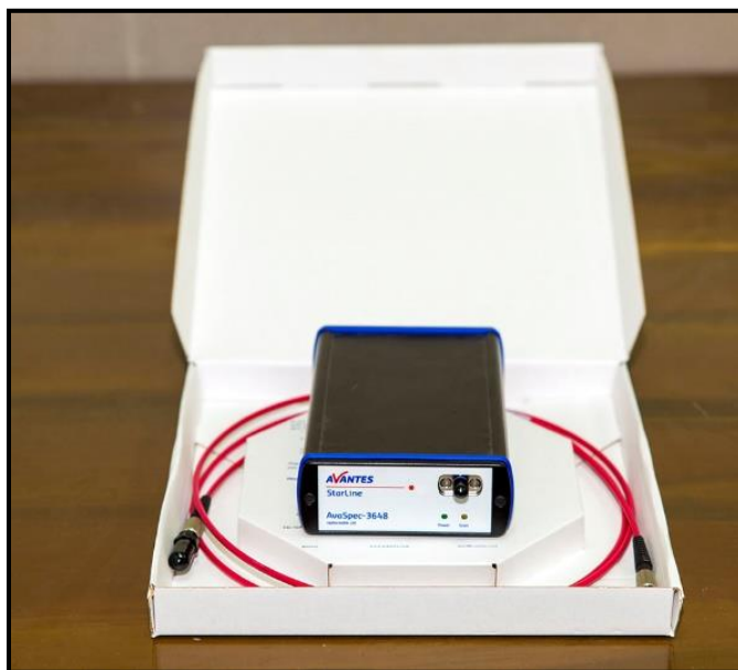
شکل ۲-۲: دستگاه طیف‌سنج گسیل نوری واقع در دانشگاه صنعتی شاهرود
