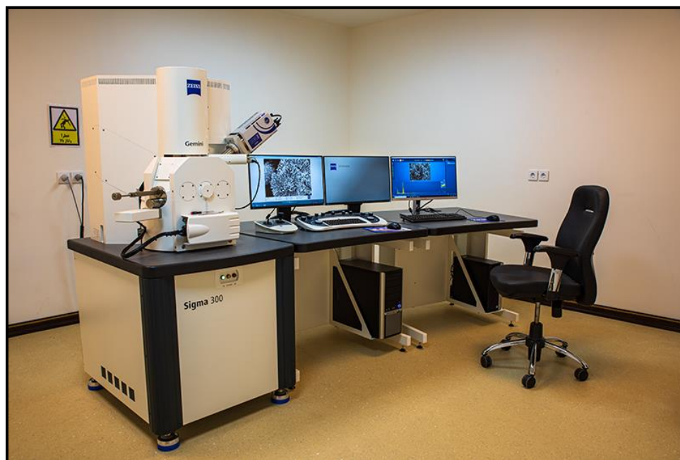
شکل ۲-۳: تصویری از دستگاه FESEM واقع در آزمایشگاه دانشگاه صنعتی شاهرود
