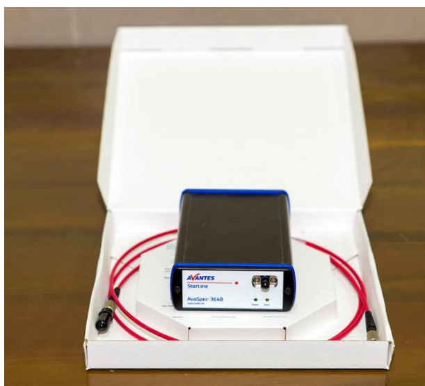
شکل ۲-۵: طیف سنج گسیل اپتیکی دانشگاه صنعتی شاهرود
