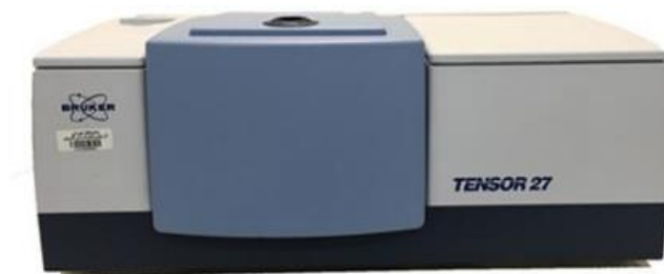
شکل ۲-۳: دستگاه FTIR-ATR دانشگاه تهران
