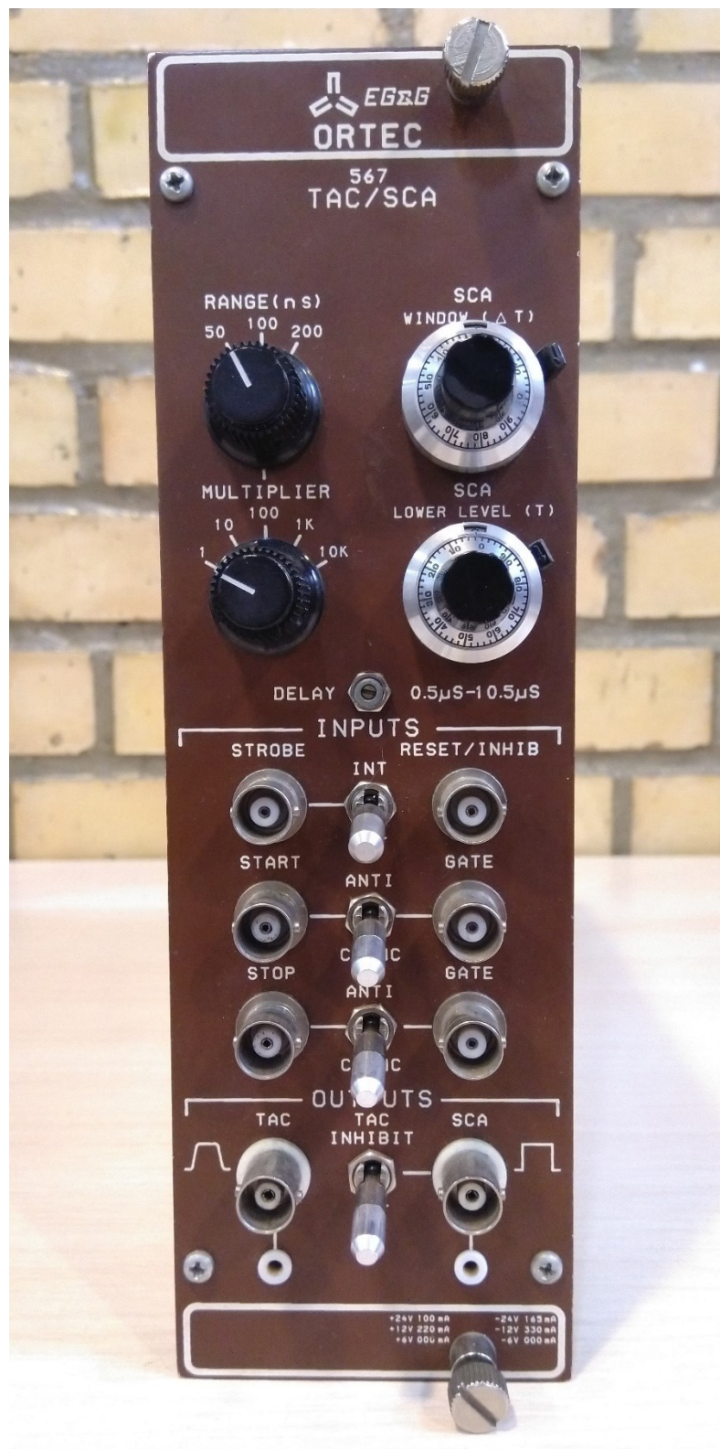
شکل ۲-۶: مازول مبدل زمان به دامنه و تحلیل گر تک کاناله
