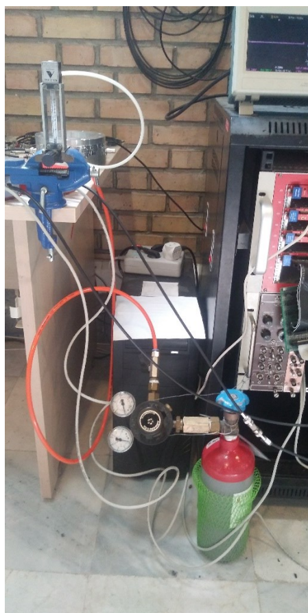
شکل ۴-۱۵: سیستم تزریق گاز
