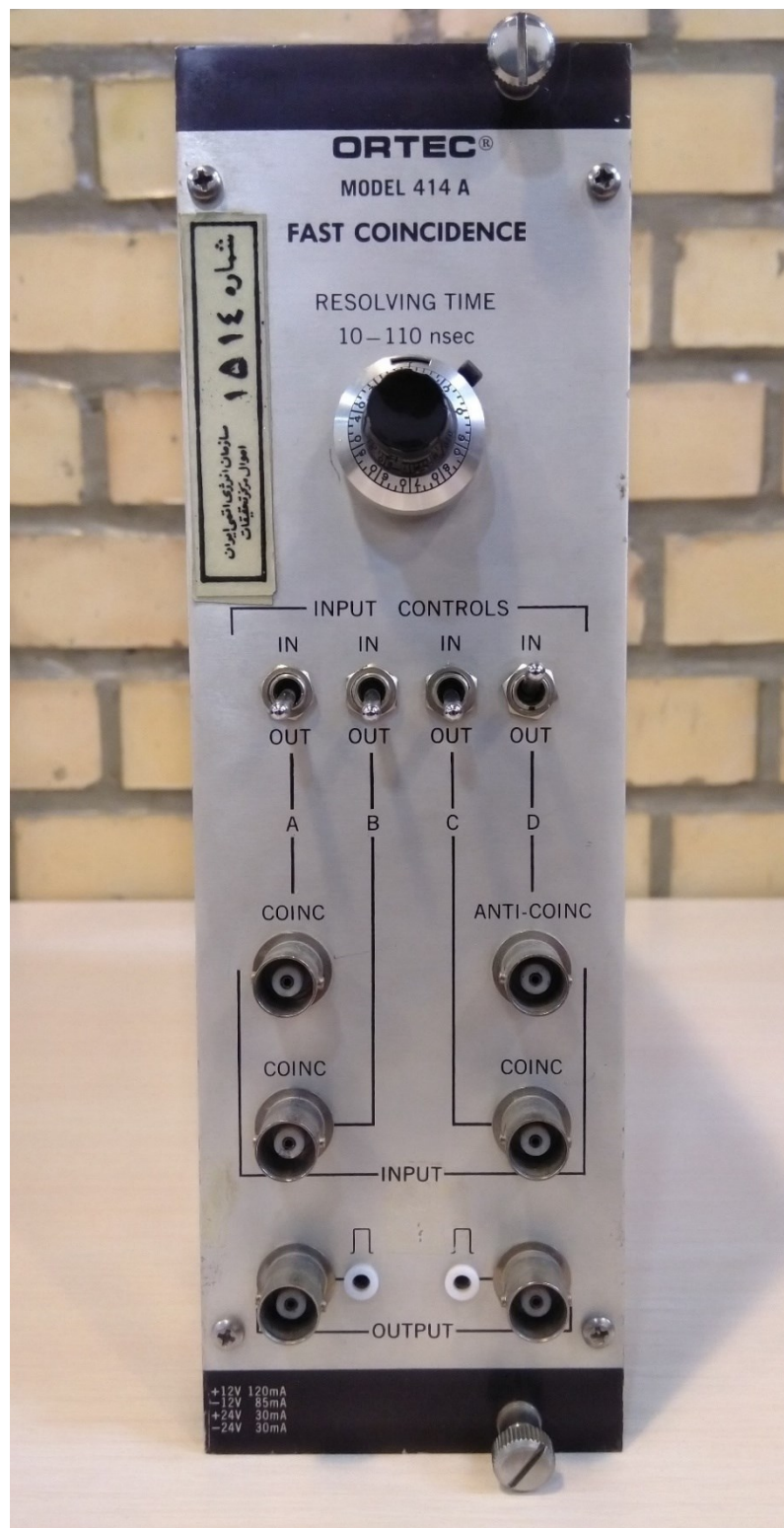
شکل ۷-۲: ماژول همفرودی سریع
