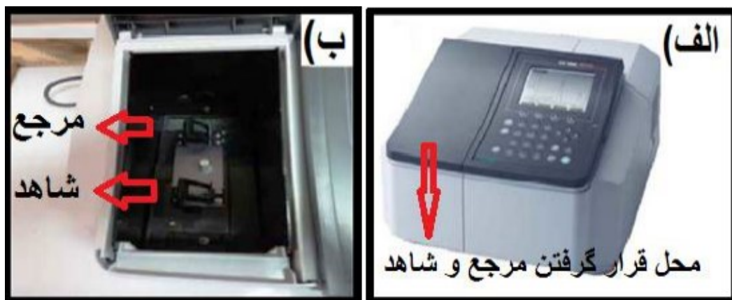
شکل ۳-۶: الف) نمایی از دستگاه اسپکتروفوتومتر مدل SHIMADZU UV1800 مستقر در آزمایشگاه نانوفیزیک دانشگاه صنعتی شاهرود (ب) محل قرار گرفتن نمونه های مرجع و شاهد.
