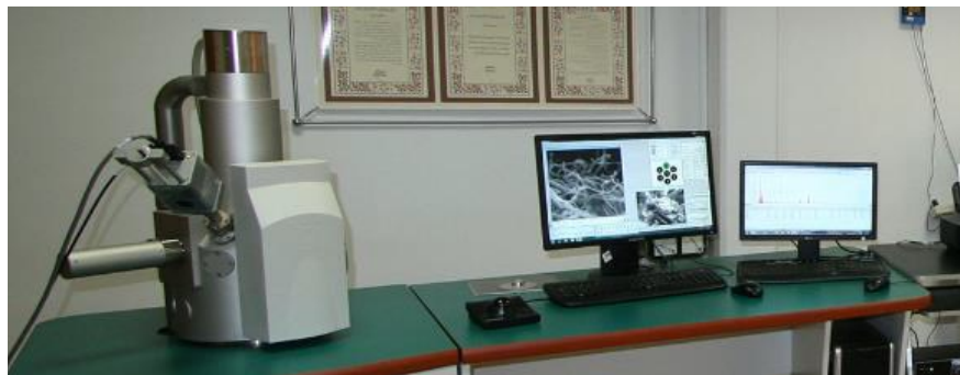
شکل ۳-۸: دستگاه SEM مدل VEGA/TESCAN-XMU مجهز به سیستم EDX.
