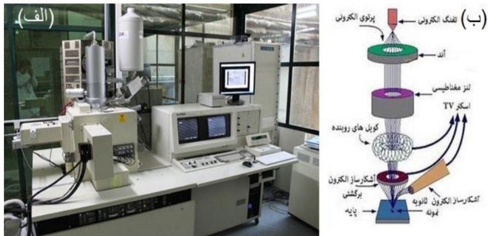
شکل ۳-۳: (الف) نمایی از میکروسکوپ الکترونی روبشی اثر میدانی استفاده شده در پایان نامه. (ب) طرحواره ای از اجزاء اصلی یک میکروسکوپ الکترونی روبشی.
