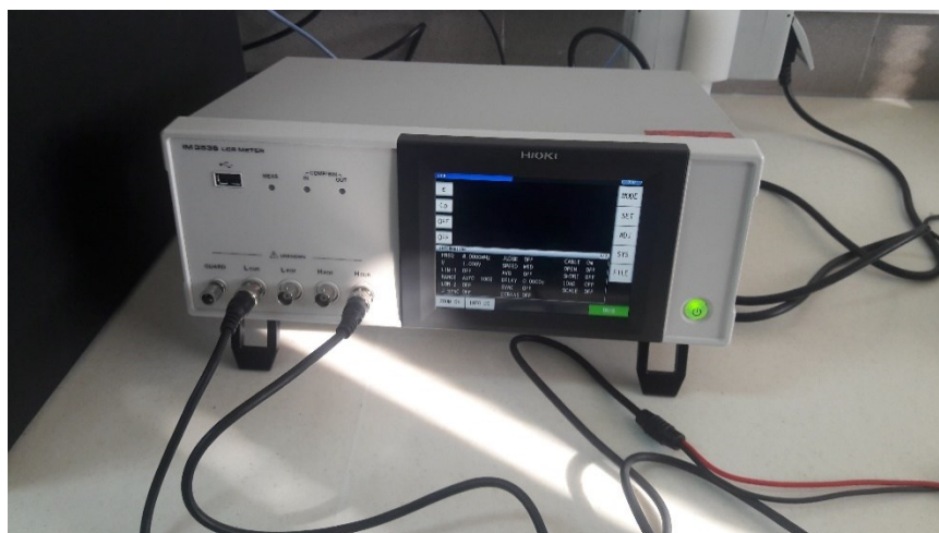
شکل ۳-۱۰: نمایی از دستگاه LCR متر مدل HIOKI IM ۳۵۳۶ مستقر در آزمایشگاه نانوفیزیک دانشگاه صنعتی شاهرود.
