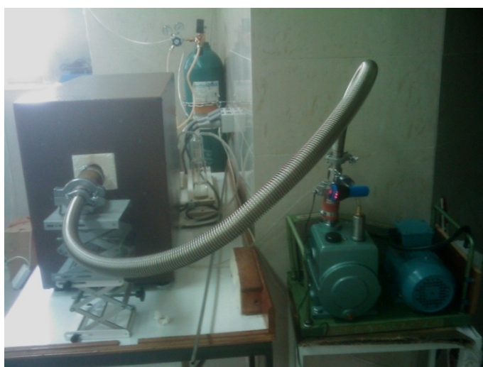
شکل(۴-۵) تصویری از سیستم خلأ مورد استفاده در لایه نشانی به روش CVD (آزمایشگاه تحقیقاتی نانو دانشگاه صنعتی شاهرود)
