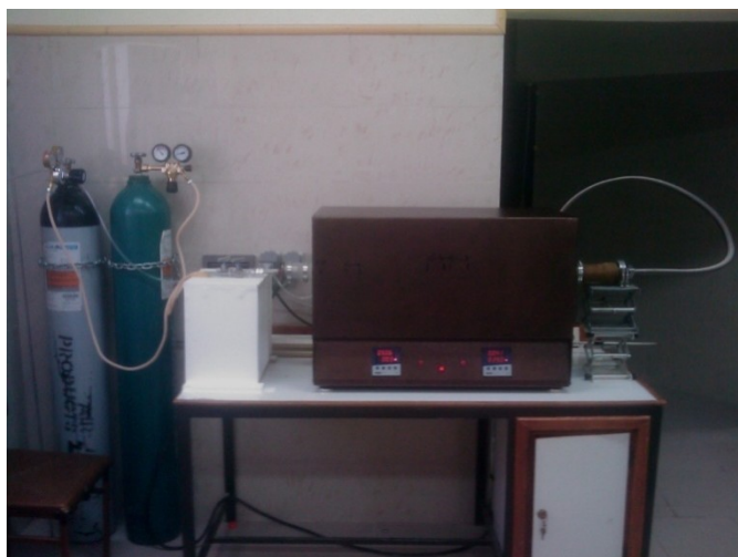
شکل (۵-۳) تصویر کوره الکتریکی بکار رفته و متعلقات آن (آزمایشگاه تحقیقاتی نانو دانشگاه صنعتی شاهرود)
