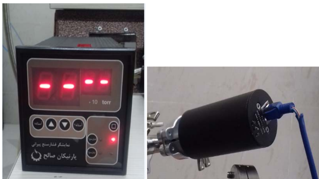
شکل ۳-۵: گیج فشارسنج پیرانی و نمایشگر دیجیتال
