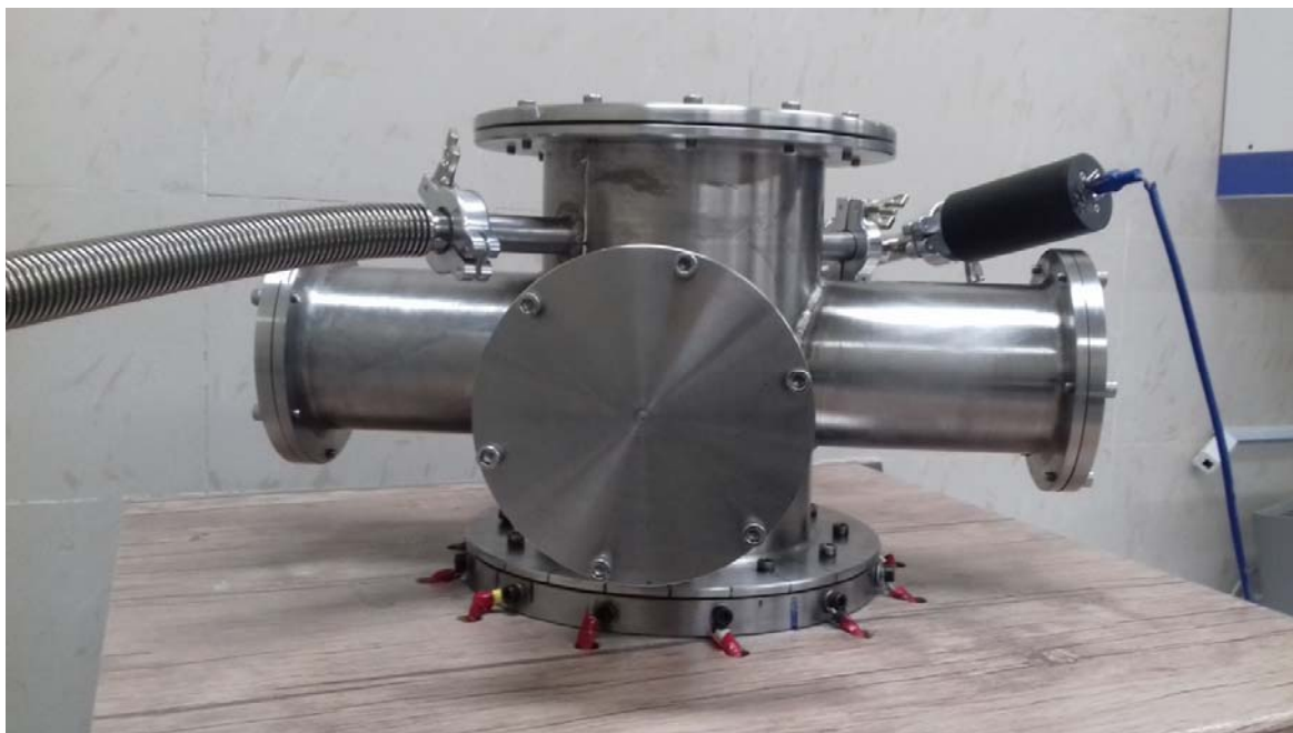
شکل ۳-۲ : محفظه تخلیه الکتریکی و خلا
