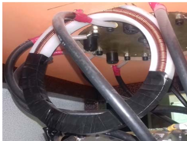
شکل ۳-۱۲: نمایی از پیچه رگوفسکی دستگاه پلاسمای کانونی شاهرود
