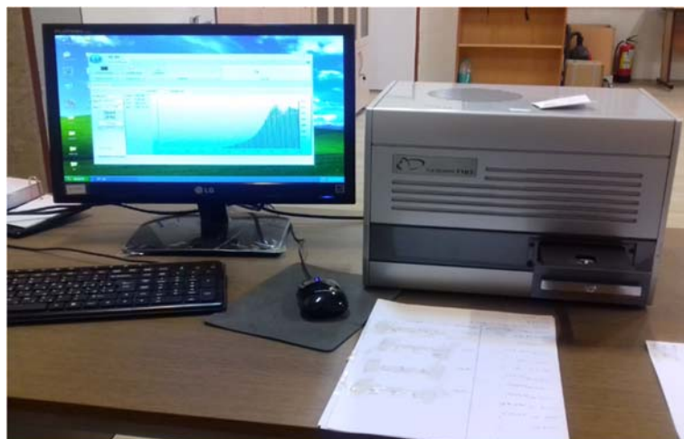
شکل ۳-۱۵: دستگاه قرائت گر (TLD) و سیستم متصل به آن
