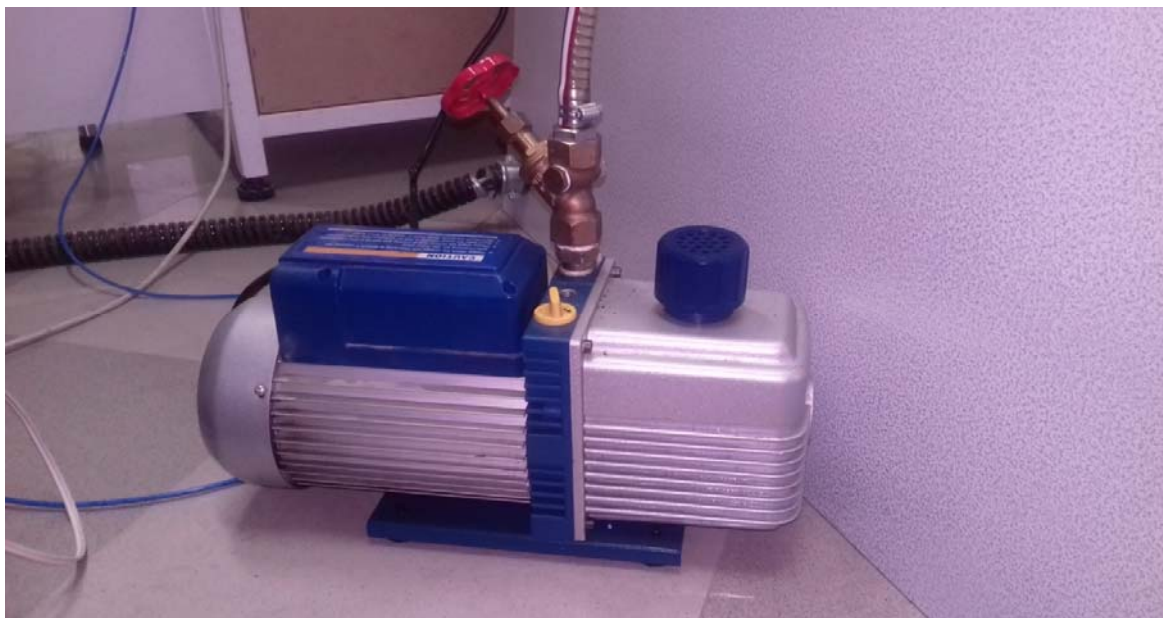
شکل ۳-۴: نمایی از پمپ روتاری دو مرحله‌ای مدل VE 280N
