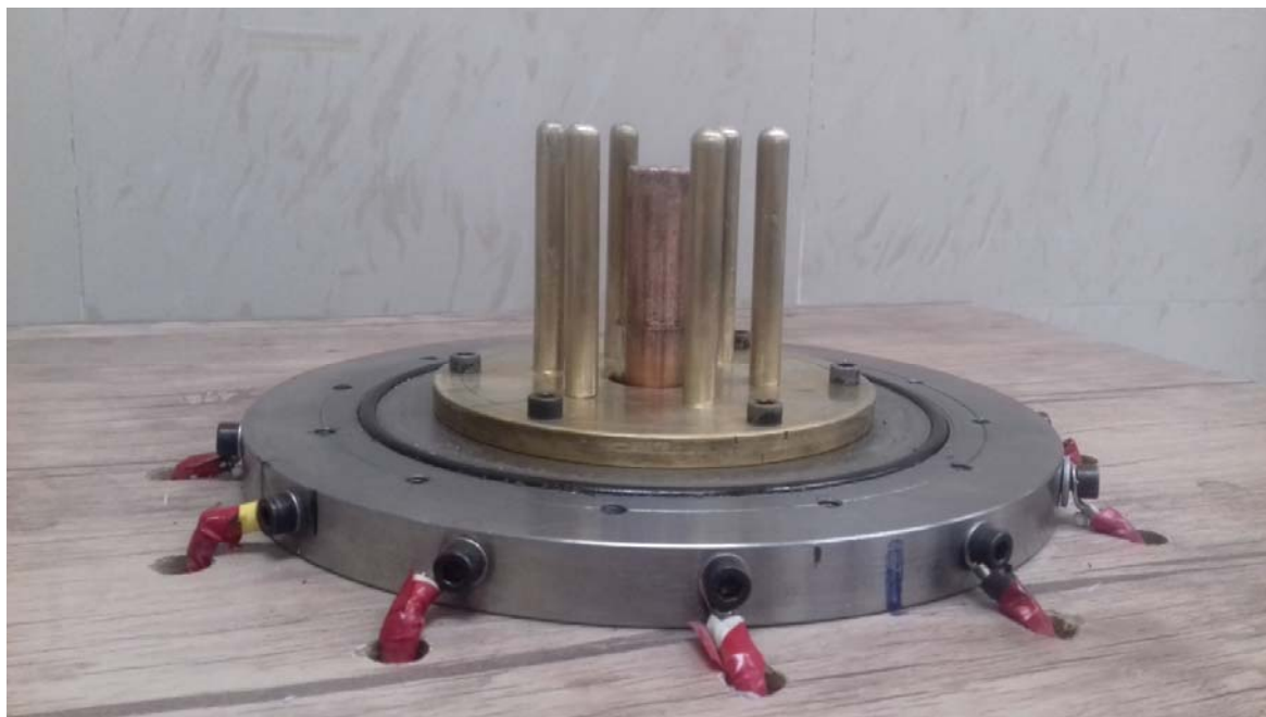
شکل ۳-۳: نمایی از آند، کاتد، عایق و صفحه پایه دستگاه
