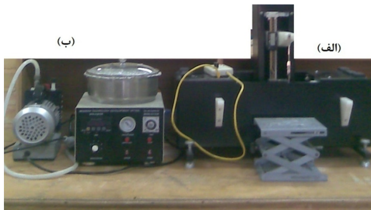
شکل ۲-۹: دستگاه‌های لایه‌نشانی به روش سل-ژل (الف) غوطه‌وری، (ب) چرخشی دانشگاه صنعتی شاهرود.
