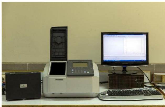
شکل ۳-۵: دستگاه طیف نگار (UV-Vis) مورد استفاده در این پایان نامه واقع در دانشگاه صنعتی شاهرود
