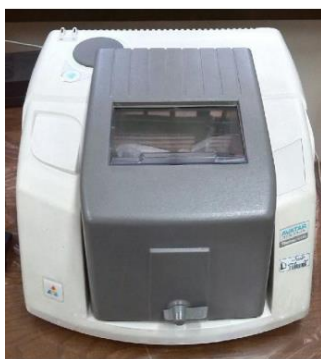
شکل ۳-۷ دستگاه طیف سنجی مادون قرمز مدل در دانشگاه فردوسی مشهد
