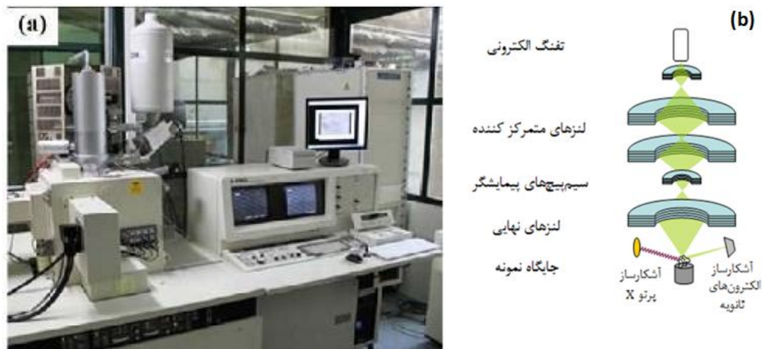
شکل ۲-۱: (a) نمایی از میکروسکوپ الکترونی روبشی گسیل میدانی (b) طرح واره‌ای از اجزاء اصلی یک میکروسکوپ الکترونی روبشی گسیل میدانی.
