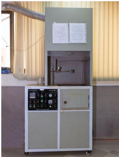
شکل ۳-۱: دستگاه اسپری پائرولیز بکار گرفته شده در دانشگاه صنعتی شاهرود.
