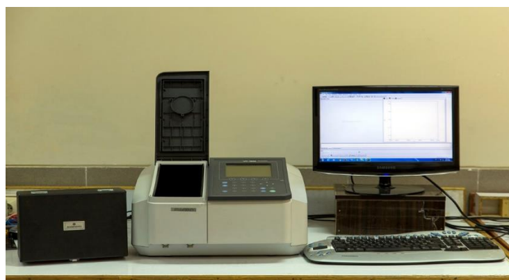
شکل ۳-۲: الف) طیف نگار UV-Vis مدل Shimadzu UV-vis. 1800 مورد استفاده در این پایان نامه
