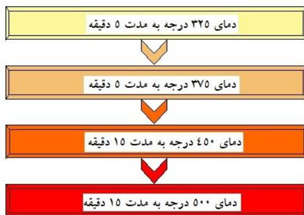
شکل ۴-۴: مراحل بازپخت لایه نازک اکسید تیتانیوم مورد استفاده در سلول خورشیدی رنگدانه‌ای
