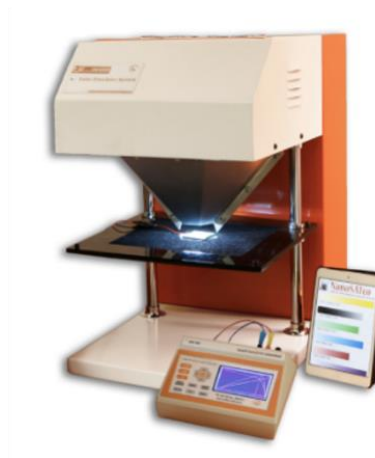
شکل ۵-۳: الف) شبیه ساز نور خورشید ب) مشخصه یاب پارامترهای سلول خورشیدی مدل NanoSAT-IIIS-200
