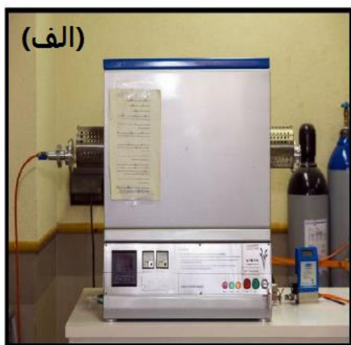
شکل ۳-۱: (الف) تصویر کوره تیوپی واقع در دانشگاه شاهرود (ب) طرح شماتیک از اجزای داخلی دستگاه.
