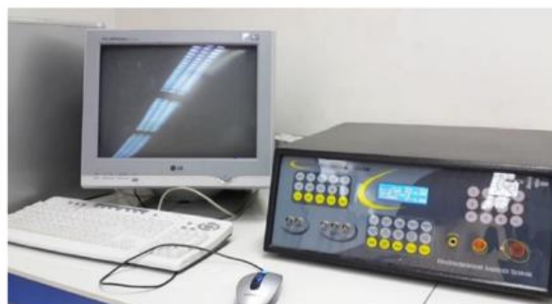
شکل ۲-۷: تصویر دستگاه نمایشگر I-V (مدل + ۲۰۶۳ BHP شرکت به پژوه) به کار گرفته شده در آزمایشگاه دانشگاه صنعتی شاهرود.
