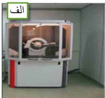
شکل ۳-۲: (الف) تصویری از دستگاه پراش پرتو X مدل Bruker-AXS در دانشگاه دامغان. (ب) محل قرار گرفتن نمونه.
