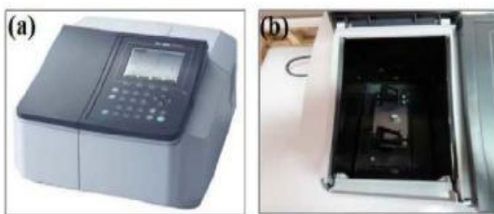
شکل ۲-۴: الف) دستگاه اسپکتروفوتومتر مدل Shimadzo (UV-Vis, 1800) دانشگاه صنعتی شاهرود. ب) جایگاه های قرارگیری نمونه های آزمایشی و شاهد برای تعیین ضرایب عبوری و جذبی.
