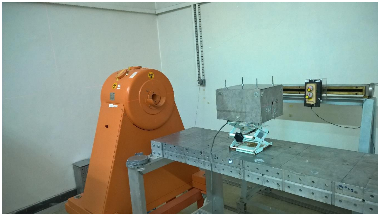
شکل (۶-۷) نمایی از قرارگیری اتاقک یونش در مقابل چشمه \text{Co}^{60} از نمای جانبی
