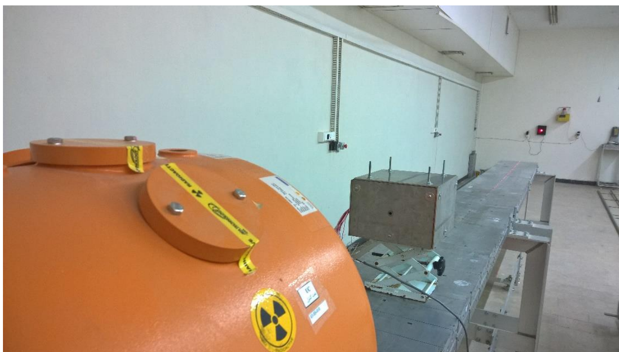
شکل (۶-۸) نحوه قرار گرفتن اتاقک یونش و چشمه \text{Co}^{60} از نمای طولی
