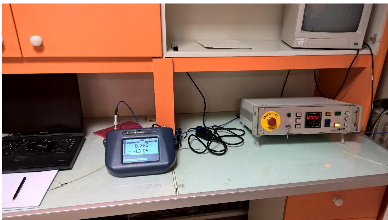
شکل (۹-۶) نمایی از صفحه کنترل چشمه \text{Co}^{60} و الکترومتر
