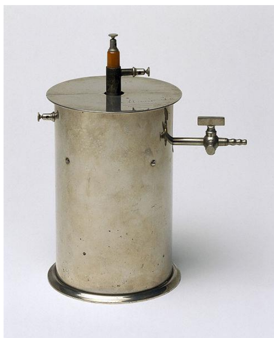
شکل (۱-۱) نمونه‌ای از اتاقک یونش ساخته شده توسط پیر کوری، ۱۸۹۵-۱۹۰۰ [۳]
