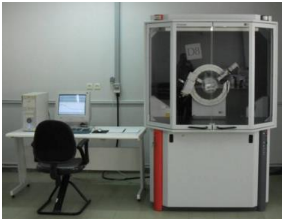
شکل ۳-۶: تصویر دستگاه پراش پرتو ایکس (XRD) استفاده شده در این کار مستقر در دانشگاه دامغان.
