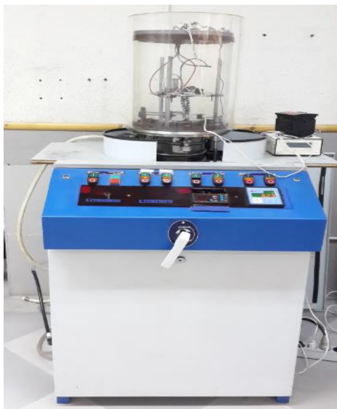
شکل ۲-۳: دستگاه تبخیر حرارتی مستقر در آزمایشگاه نانوفیزیک دانشگاه صنعتی شاهرود.
