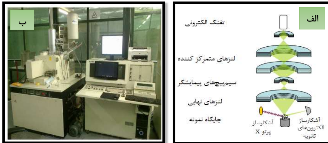
شکل ۲-۱: (الف) طرح کلی یک میکروسکوپ الکترونی روبشی (FESEM) و (ب) نمایی از دستگاه FESEM مدل Hitachi S.4160 در دانشگاه تهران، به کار رفته در بررسی مورفولوژی سطح نمونه ها.
