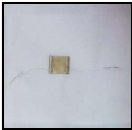
شکل ۲-۴: اتصال فلز - نیم رسانا برای اندازه گیری رسانندگی نمونه ها.
