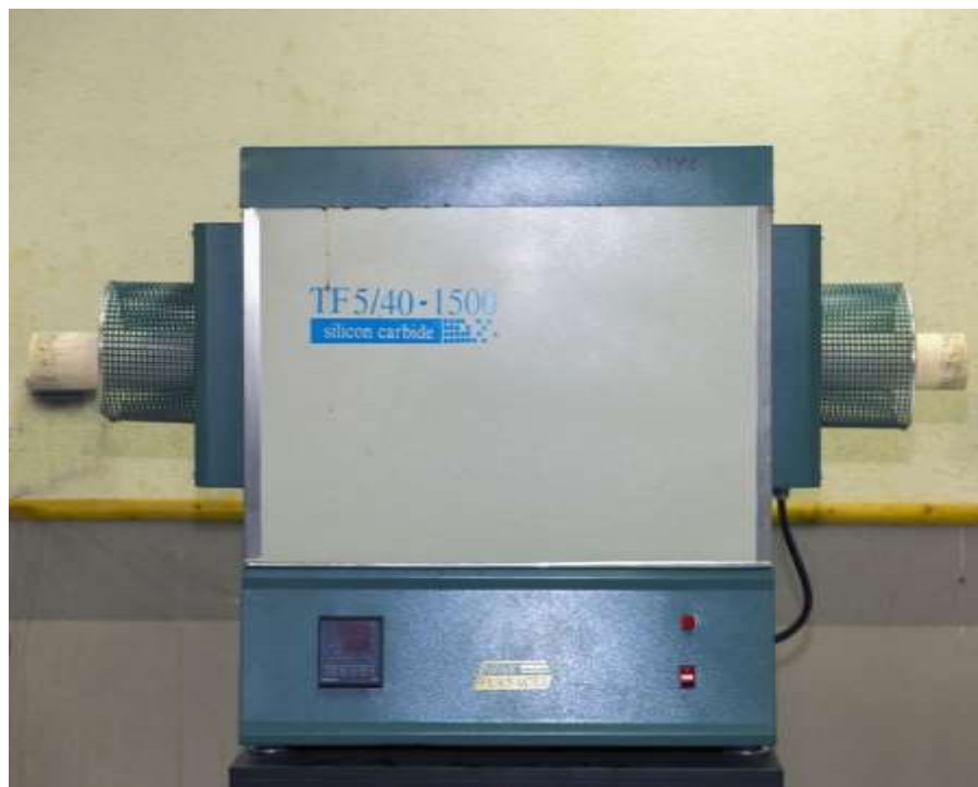
شکل ۳-۳: تصویر کوره ی تیوپی مدل TF5/40-1500 در دانشگاه صنعتی شاهرود، به کار رفته برای انجام بازپخت.
