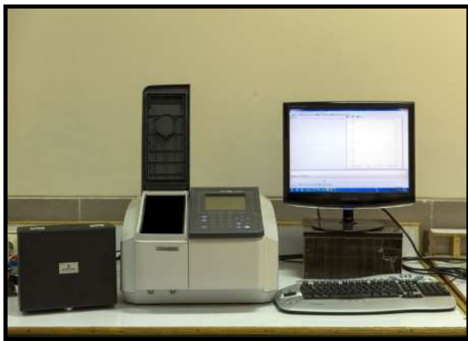
شکل ۴-۲: دستگاه طیف سنج UV-Vis مدل Shimadzu – 1800 در دانشگاه صنعتی شاهرود به کار رفته در مشخصه یابی اپتیکی نمونه ها.
