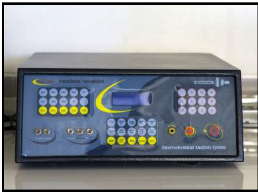
شکل ۲-۵: تصویر دستگاه آنالیز الکترو شیمیایی مدل PGS 2065 در دانشگاه صنعتی شاهرود، به کار رفته در بررسی رسانندگی سطحی نمونه ها.
