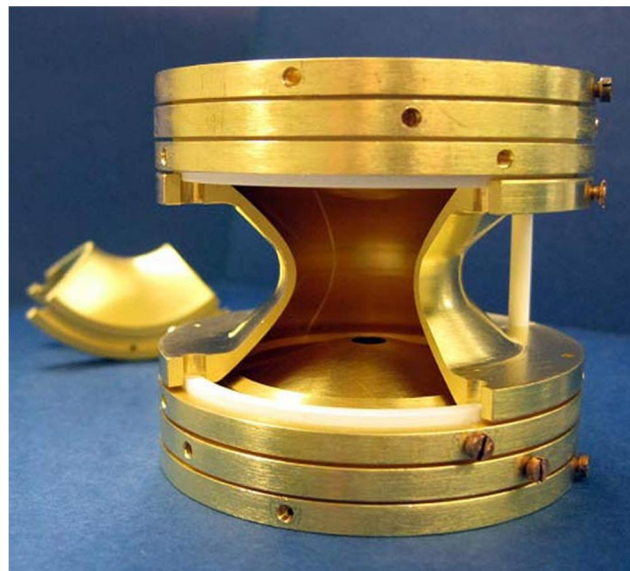
شکل ۱-۷-۱: تله یونی پنینگ کلاسیک متشکل از یک حلقه و دو کلاهک در بالا و پایین آن.
