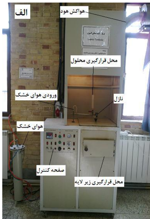
شکل ۱-۲: (الف) دستگاه اسپری پایرولیز مدل (S.C.S.86) استفاده شده در این تحقیق موجود در دانشگاه صنعتی شاهرود (ب) طرح شماتیک از دستگاه اسپری پایرولیز.
