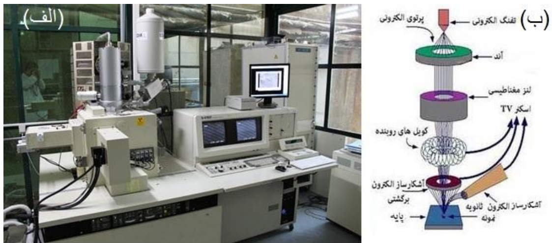
شکل ۲-۶: (الف) دستگاه میکروسکوپ الکترونی روبشی گسیل میدانی (FESEM) مدل Hitachi S-41600 مورد استفاده در این پایان نامه ، (ب) تصویر طرح‌وار از اجزای داخلی دستگاه [۲۲].
