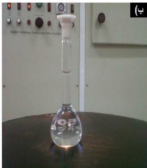
شکل ۳-۳: (الف) مرحله حل شدن پودر WO_3 در حلال آمونیاک بر روی هیتر ، (ب) محلول تنگستات آمونیوم بدست آمده.
