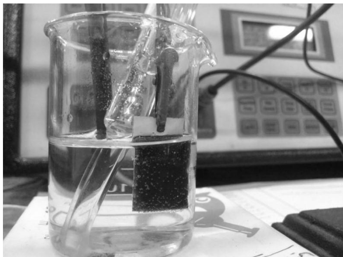
شکل ۲-۱۳: آزمایش اکسایش و کاهش و تغییر رنگ نمونه
