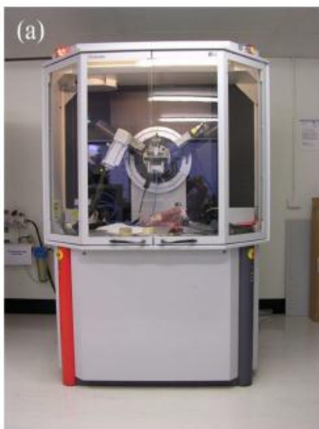
شکل ۲-۳: (a) دستگاه پراش پرتو X مدل Bruker-AXS در دانشگاه دامغان. (b) محل قرار گرفتن دستگاه نمونه.
