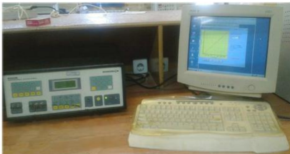
شکل ۲-۱۰ : تصویر دستگاه مشخصه یابی I-V ( مدل + BHP 2063 شرکت به پروژه) به کار گرفته شده در
