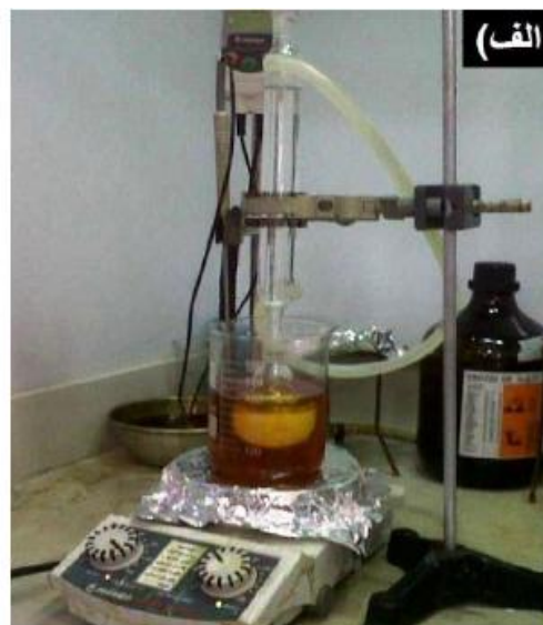
شکل ۳-۳: (الف) مرحله حل شدن پودر WO_3 در حلال آمونیاک بر روی هیتر ، (ب) محلول تنگستات آمونیوم بدست آمده.
