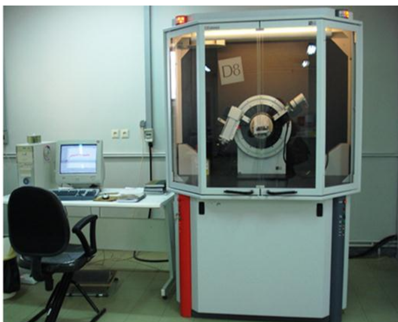
شکل ۲-۳ دستگاه پراش پرتو ایکس مورد استفاده جهت مطالعه ساختار لایه ها در دانشگاه دامغان
