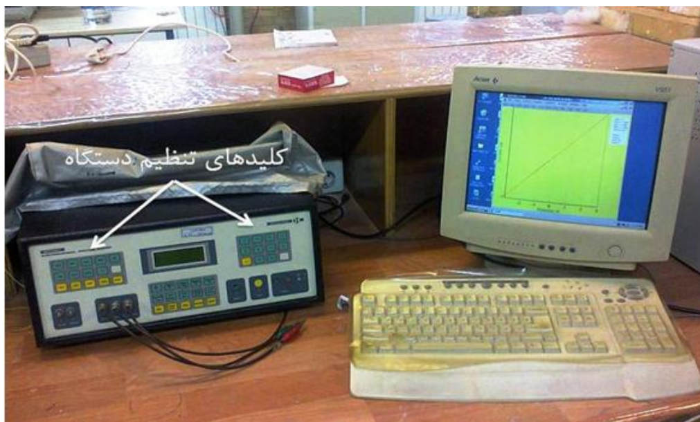
شکل ۶-۲: دستگاه پتانسیومتر آنالیز الکتروشیمیایی مدل (Behpajoooh- BHP2063t) موجود در دانشگاه شاهرود
