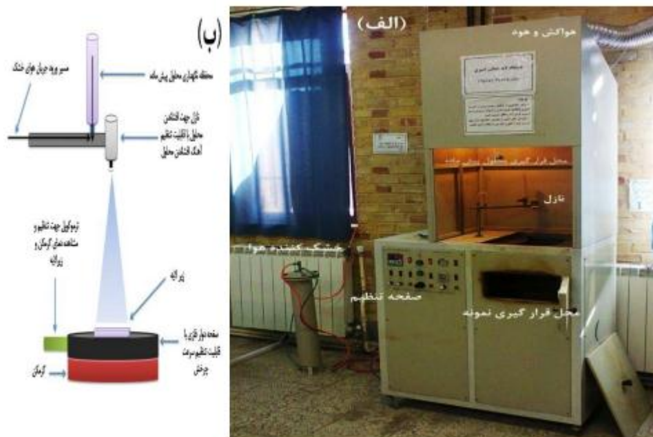
شکل ۳-۱ (الف) دستگاه افشانه تجزیه حرارتی مدل (Spray Coating System.S.C.S.86)
