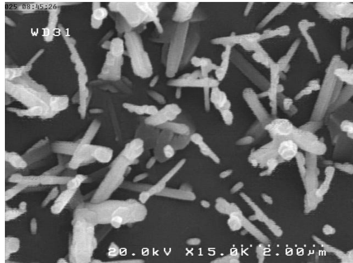
شکل ۴-۳ رشد نانومیل‌های با جهت‌گیری تصادفی بر روی بستر شیشه در دمای ۵۵۰ درجه سانتیگراد
