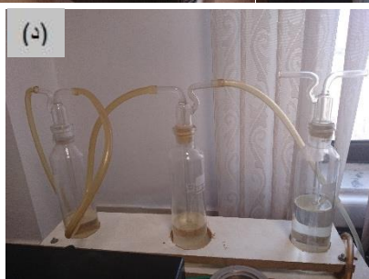
شکل ۳-۱: تصاویر کوره الکتریکی و اجزای آن، (الف) کوره، (ب) سیستم خلا، (ج) کپسول‌ها، (د) گازشوی، (و) شار سنج‌ها
