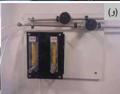
شکل ۳-۱: تصاویر کوره الکتریکی و اجزای آن، (الف) کوره، (ب) سیستم خلا، (ج) کپسول‌ها، (د) گازشوی، (و) شار سنج‌ها
