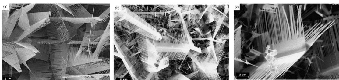
شکل ۳-۷: مورفولوژی‌های گوناگون از نانوشانه‌های اکسید روی که به دلیل تغییر شار اکسیژن به دست آمده‌اند [۳۳]
