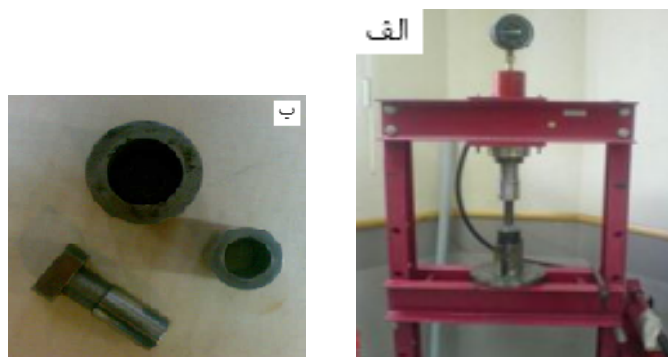
شکل ۳-۲: الف) دستگاه پرس موجود در دانشگاه شاهرود ب) قالب استوانه‌ای.
