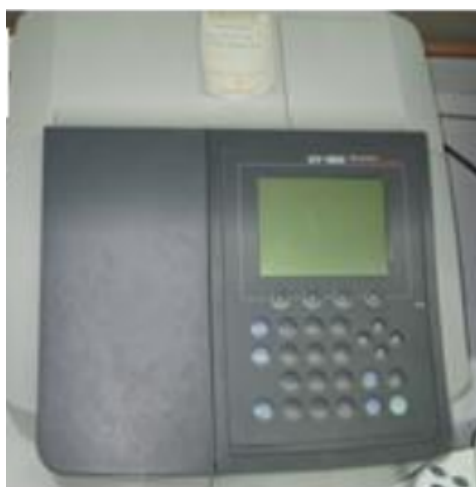
شکل ۲-۵: نمایی از یک دستگاه طیف‌سنج uv-vis [۱۹].
