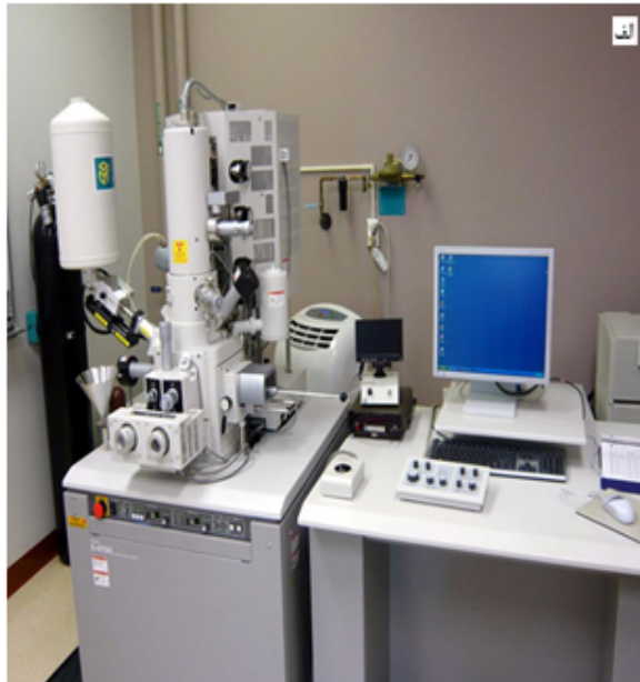
شکل ۲-۴: الف) نمای از یک میکروسکوپ الکترونی روبشی گسیل میدانی ب) طرح‌واره‌ای از
