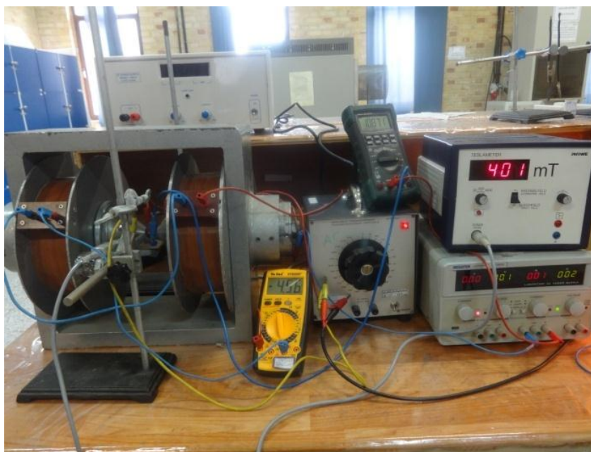
شکل ۸-۲: دستگاه استفاده شده برای محاسبه مقاومت مغناطیسی در دانشگاه شاهرود.
