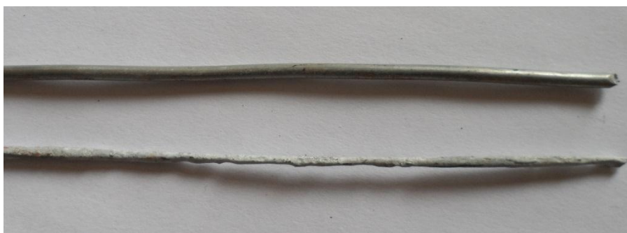
شکل ۵-۱۳: تصویر الکترودهای Zn قبل و بعد از تخلیه الکتریکی
