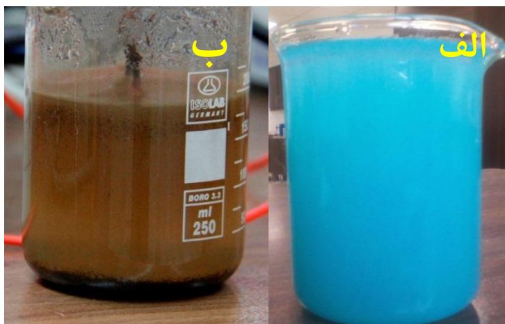
شکل ۴-۱۶ : الف ( نمونه سنتز شده با جریان DC ب) نمونه سنتز شده با جریان AC
