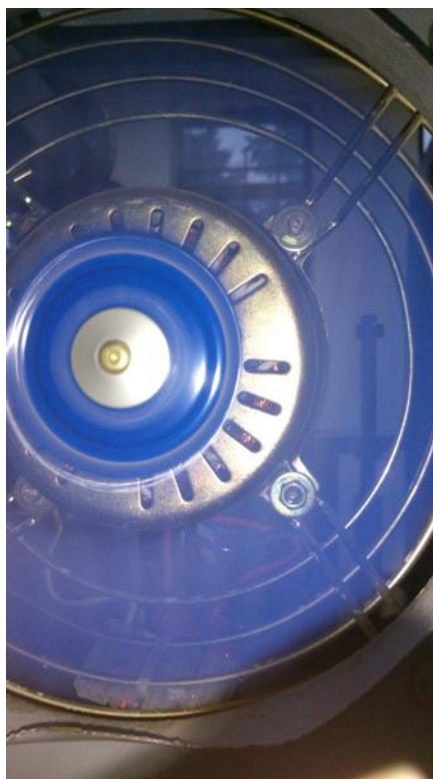
شکل ۳-۱۲ : پروانه خنک کننده موتورها و قندانی‌ها
