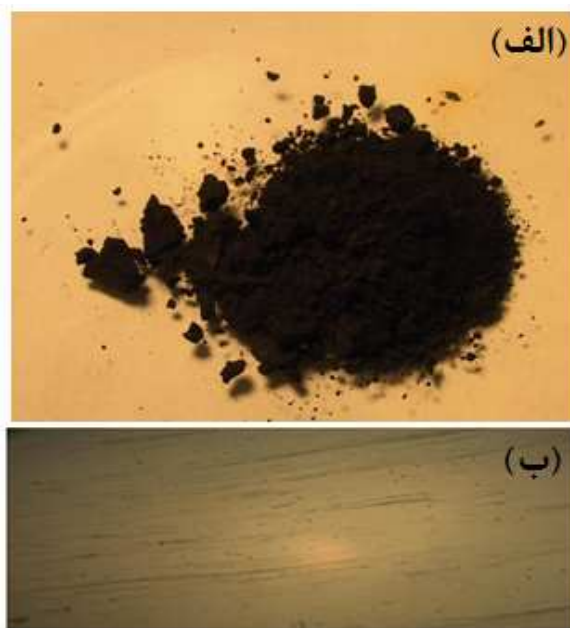
شکل ۱-۲- (الف) پودر خالص سیاه رنگ CuO [۶] و (ب) تصویر میکروگراف لایه نازک اکسید مس [۵]
