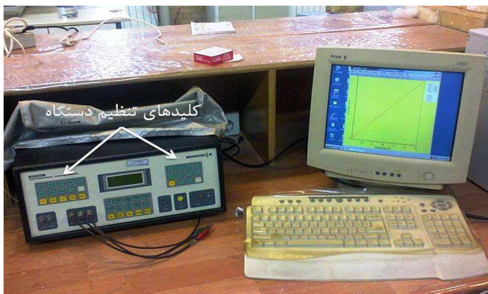
شکل ۲-۵- دستگاه پتانسیومتر آنالیز الکتروشیمیایی BehpajooH-BHP2063t موجود در دانشگاه شاهرود
