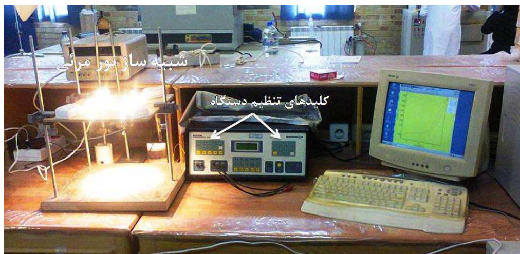
شکل ۶-۲- نمایش از سیستم نوردهی توسط لامپ هالوژن جهت بررسی رفتار پیوندگاه تحت تابش.
