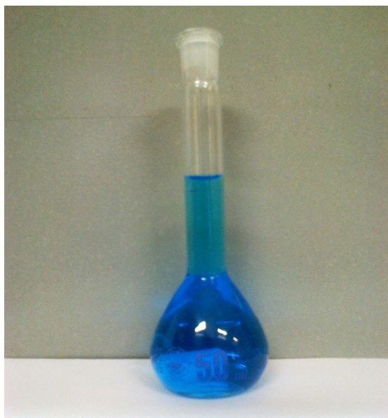
شکل ۳-۳- محلول استات مس ۰/۱M به دست آمده جهت لایه نشانی
