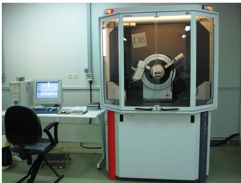
شکل ۲-۲- دستگاه پراش سنج مورد استفاده جهت مطالعه ساختاری لایه‌ها، واقع در دانشگاه دامغان
