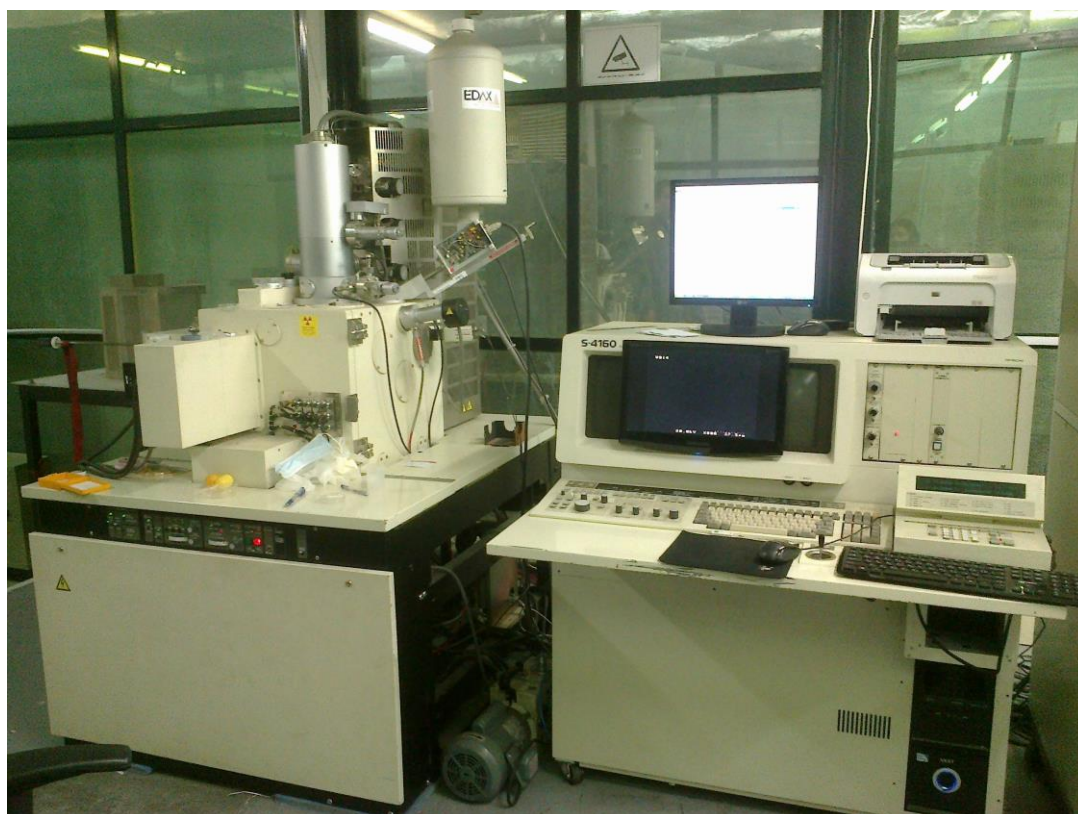
شکل ۲-۳: تصویر از دستگاه FESEM مستقر در دانشکده مهندسی برق دانشگاه تهران.
