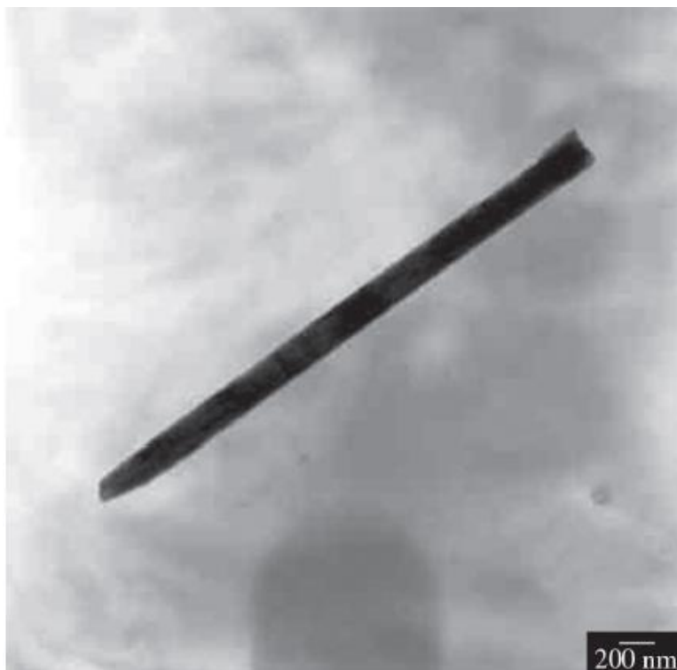
شکل ۹-۱: تصویر TEM نانوسیم آزاد شده از قالب [۱۱].
