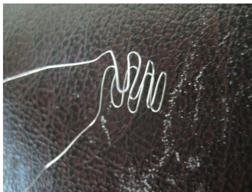
شکل ۲-۴: نمونه‌ی آزمایشی هیتر پیچیده شده در زیر لایه
