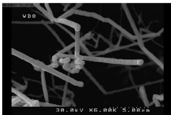
شکل ۵: تصویر SEM از نانو میله های رشد داده شده \text{SnO}_2 با شار گاز واکنشگر ۱۰۰ sccm
