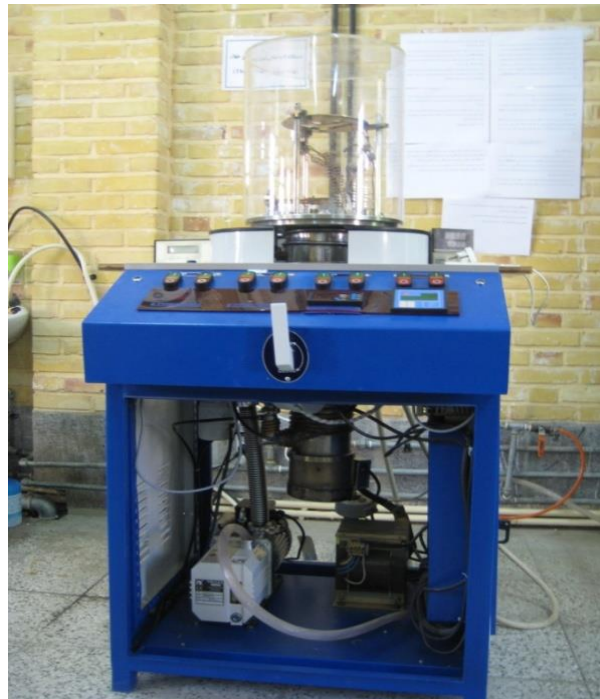
شکل ۴-۱ : دستگاه تبخیر حرارتی موجود در آزمایشگاه نانوفیزیک دانشگاه صنعتی شاهرود
