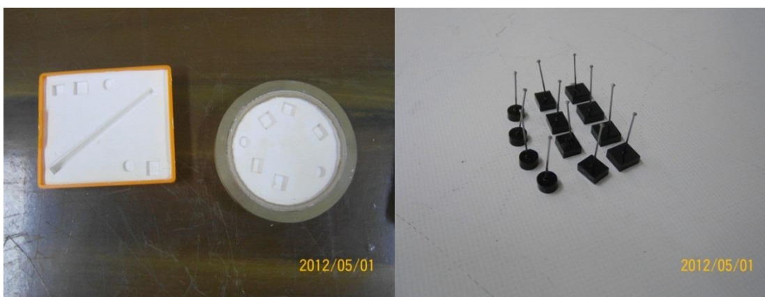
شکل ۲-۵: قالب‌های آماده شده برای زیرلایه
