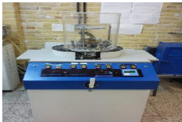
شکل ۵-۹- دستگاه تبخیر حرارتی موجود در آزمایشگاه نانوفیزیک دانشگاه صنعتی شاهرود.
