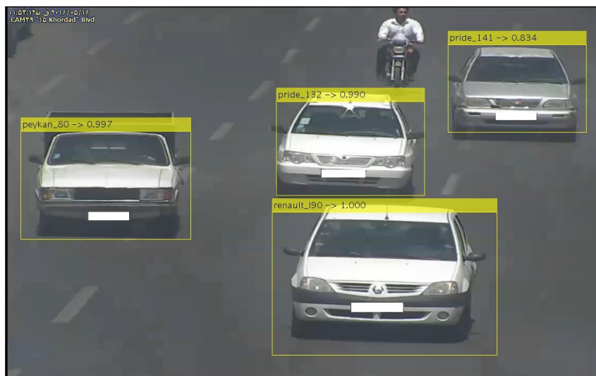
شکل ۷-۵: خروجی سیستم بر روی یک نمونه تصویر از مجموعه داده BVMMR. مدل همه خودروهای موجود در تصویر به درستی تشخیص داده شده است.
