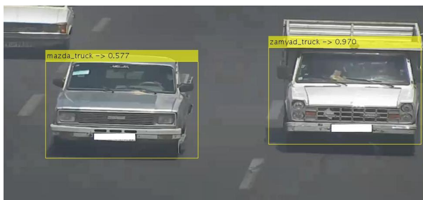
شکل ۷-۸: خروجی سیستم بر روی یک نمونه تصویر از مجموعه داده BVMMR. مدل همه خودروهای موجود در تصویر به درستی تشخیص داده شده است.
