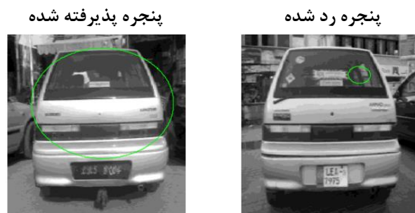
شکل ۲-۲۴: یک نمونه پنجره تأیید شده (سمت چپ) و یک نمونه پنجره‌ی رد شده (سمت راست) توسط روش پیشنهادی در [۶۱].
