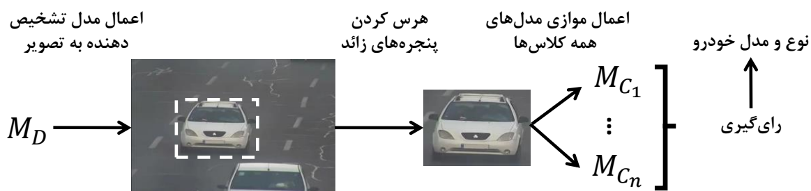
شکل ۵-۱: مراحل کلی شناسایی نوع و مدل خودرو توسط سیستم غیرآبشاری.
