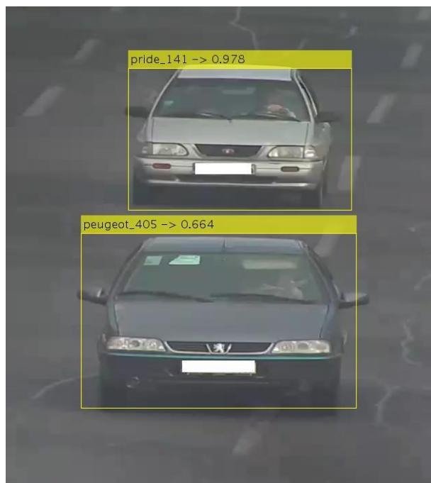
شکل ۷-۱۱: خروجی سیستم بر روی یک نمونه تصویر از مجموعه داده BVMMR. مدل خودروی پژو ۴۰۵ GLX به اشتباه پژو ۴۰۵ تشخیص داده شده است.
