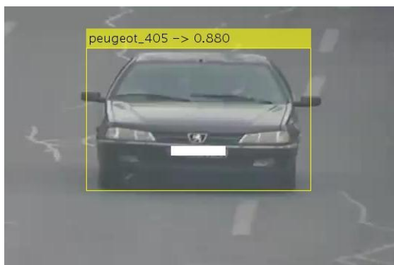
شکل ۷-۱۳: خروجی سیستم بر روی یک نمونه تصویر از مجموعه داده BVMMR. مدل خودروی پژو پارس به اشتباه پژو ۴۰۵ تشخیص داده شده است.
