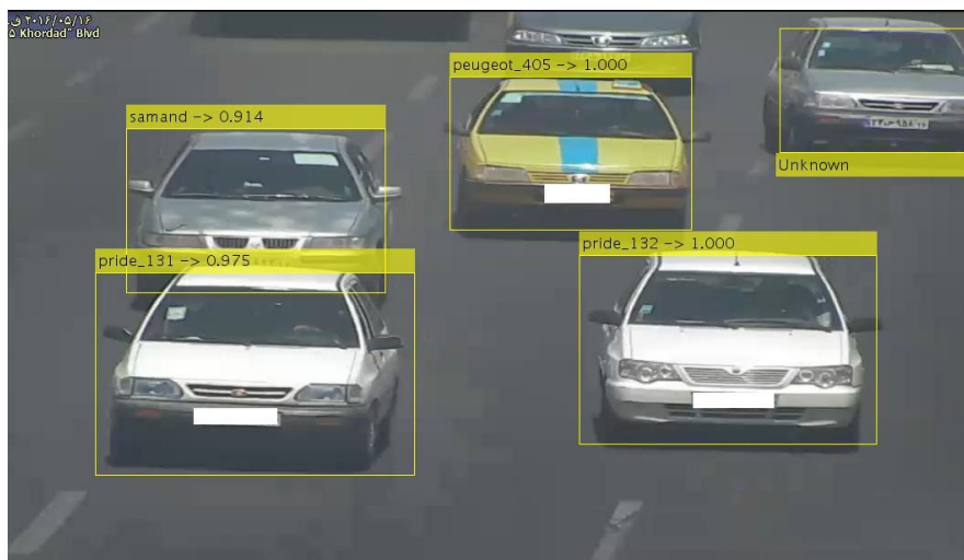
شکل ۷-۹: خروجی سیستم بر روی یک نمونه تصویر از مجموعه داده BVMMR. مدل همه خودروهای موجود در تصویر به درستی تشخیص داده شده است.
