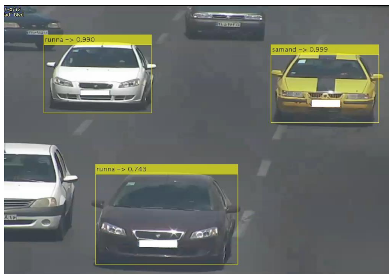
شکل ۷-۱۰: خروجی سیستم بر روی یک نمونه تصویر از مجموعه داده BVMMR. مدل همه خودروهای موجود در تصویر به درستی تشخیص داده شده است.
