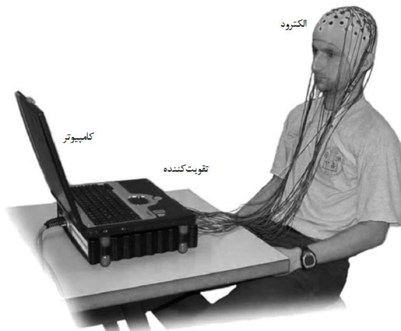
شکل ۱-۱. اجزای یک سیستم BCI [۲]
