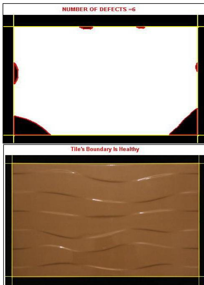
شکل (۳-۲۵) نتایج آشکارسازی عیوب برای کاشی معیوب و سالم
