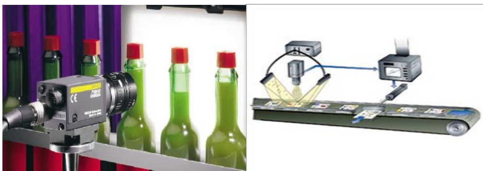
شکل (۱-۱) نمونه‌هایی از سیستم‌های بازرسی چشمی خودکار. سمت راست: طرحی از یک سیستم بینایی ماشین برای جداسازی محصولات معیوب در خط تولید. تصویر از [۶]. سمت چپ: یک سیستم بینایی ماشین برای بازرسی بسته بندی ظروف مواد غذایی. عکس از [۸]
