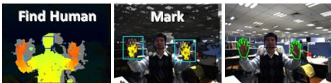
شکل ۲-۸- مراحل مختلف الگوریتم قطعه بندی دست از دوربین های استریو توسط وانگ و همکارانش. تشخیص فرد (سمت چپ)، شناسایی مکان دست (وسط) و بدست آوردن پیکسل های دست (سمت راست). تصویر از [۲۴].
