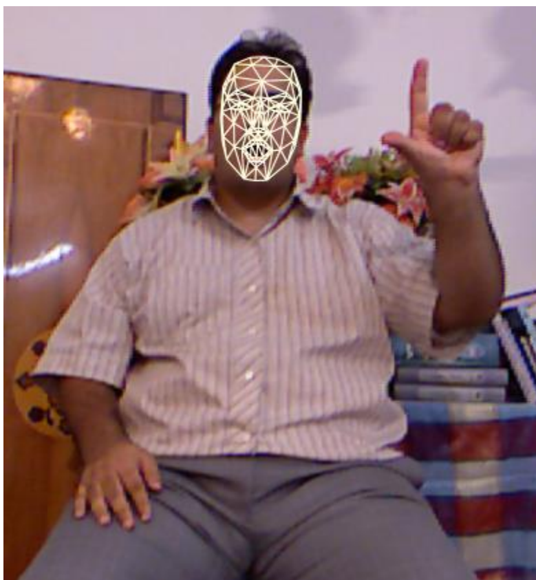
شکل ۳-۳- نمایش از ۱۲۱ نقطه استخراج شده از صورت که به صورت شبکه ای بر روی صورت منطبق شده است.
