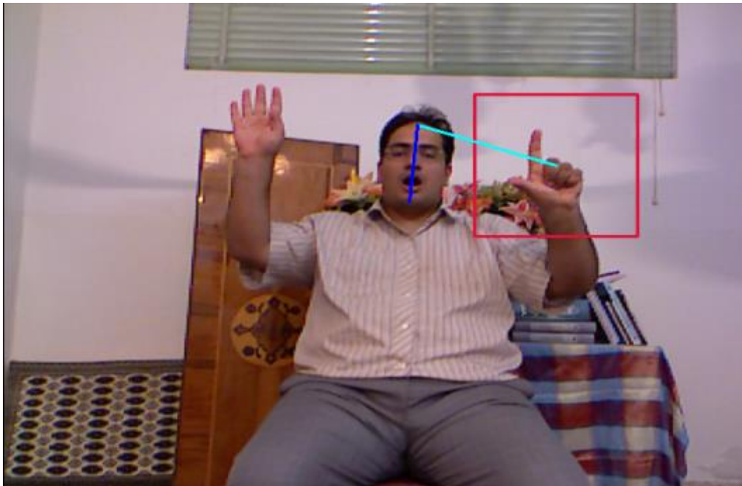
شکل ۳-۲۵ - تصویر محدوده استخراج شده اطراف دست، خط بالای سر تا دست و خط بالای سر تا چانه.
