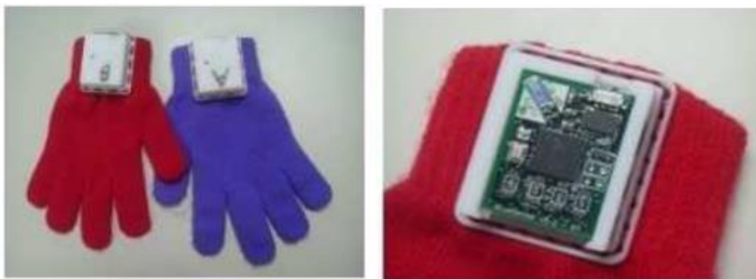
شکل ۲-۳- تصویری از دستکش‌های رنگی به همراه شتاب سنج و جزئیات شتاب سنج سه بعدی به کار رفته در بازی Copy Cat [۴]
