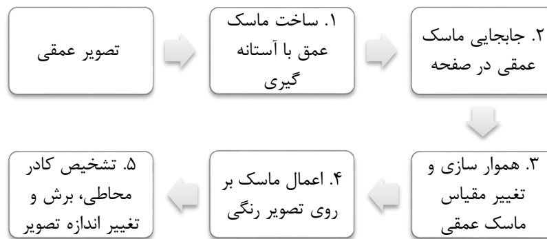
شکل ۳-۱۸- مراحل مختلف پیش پردازش انجام شده بر روی داده های تصویر. نمودار از [۳۱]
