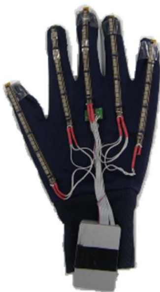
شکل ۲-۴- نمایش از دستکش و شبکه حسگری بکار رفته در تحقیق ساجاکارن و همکارانش. [۱۹]
