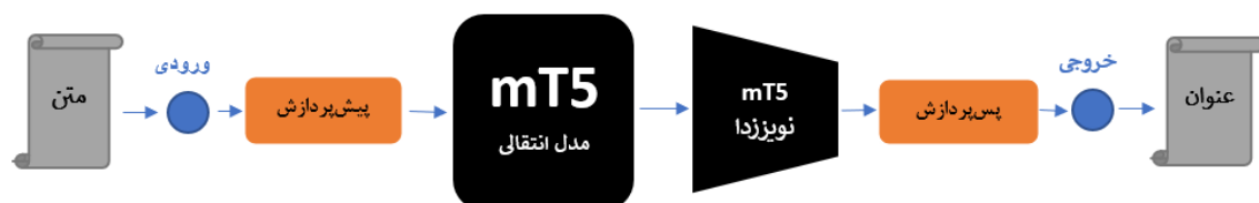
شکل ۴-۵ معماری پیشنهاد شده شماره یک برای عنوان‌ساز فارسی چکیده‌ای، همون طور که مشاهده می‌شود از چند ماژول پیش‌پردازش و پس‌پردازش، مدل انتقالی و نویززدا تشکیل شده است.
