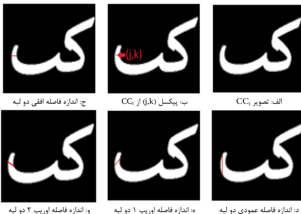
شکل ۳-۱۵: نحوه استخراج اندازه پهناهای پیکسل (j,k)
