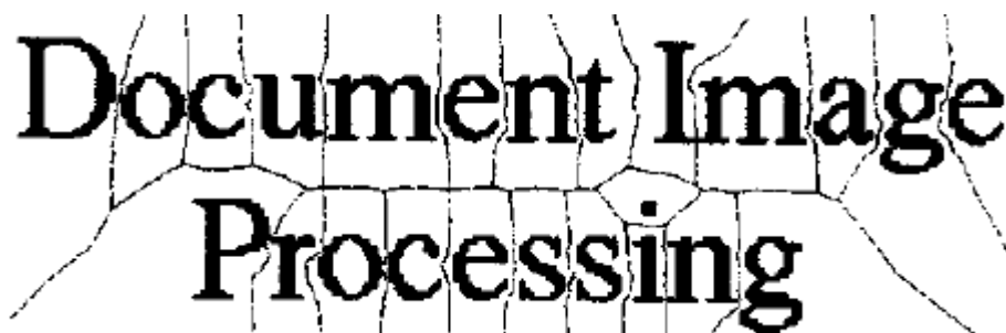
شکل ۱۰-۲: نواحی تقسیم‌شده توسط نمودار ورونوی در یک تصویر حاوی CCهای کاراکتری در مرجع [۵۹]
