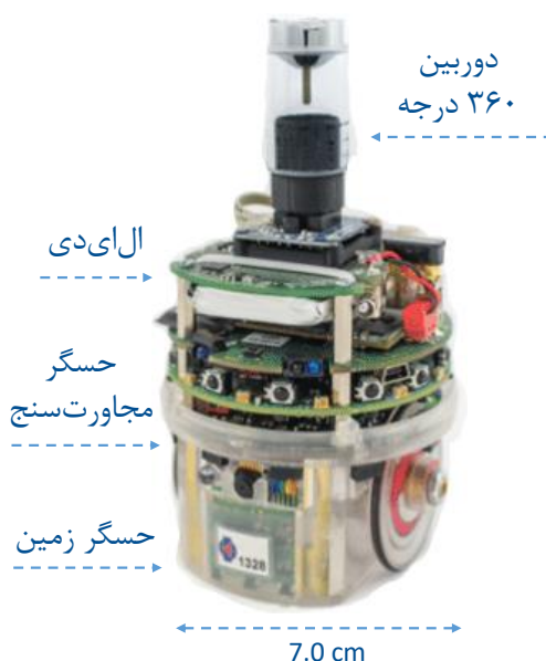
شکل ۴-۹: معرفی حسگرها و محرک‌های کاربردی ربات E-puck.
