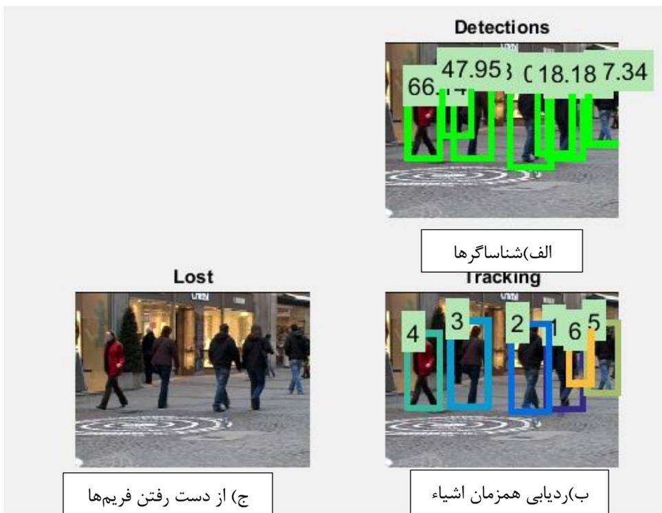
شکل ۴-۴ تشخیص و ردیابی اشیاء در مرحله آزمایش
