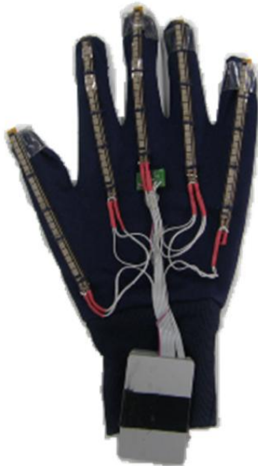
شکل ۲-۷-نمایی از دستکش و شبکه حسگری بکار رفته در تحقیق ساجاکارن و همکارانش. [۳۷]
