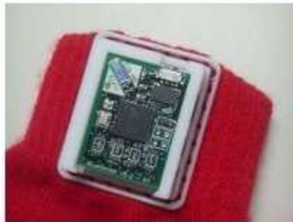
شکل ۲-۴- تصویری از دستکش های رنگی به همراه شتاب سنج (بالا) و جزئیات شتاب سنج سه بعدی (پایین) به کار رفته در بازی Copy Cat [۲]
