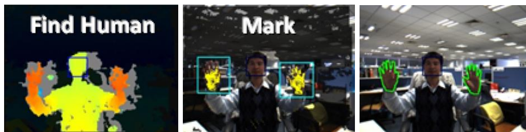
شکل ۱۳-۲- مراحل مختلف الگوریتم قطعه بندی دست از دوربین های استریو توسط وانگ و همکارانش. تشخیص فرد (سمت چپ)، شناسایی مکان دست (وسط) و بدست آوردن پیکسل های دست (سمت راست). تصویر از [۲۶].
