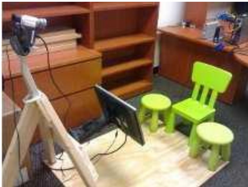
شکل ۳-۲- تصویری از یک کیوسک مخصوص بازی CopyCat که توسط دوربین از حرکات دست تصویربرداری می شود. [۲]
