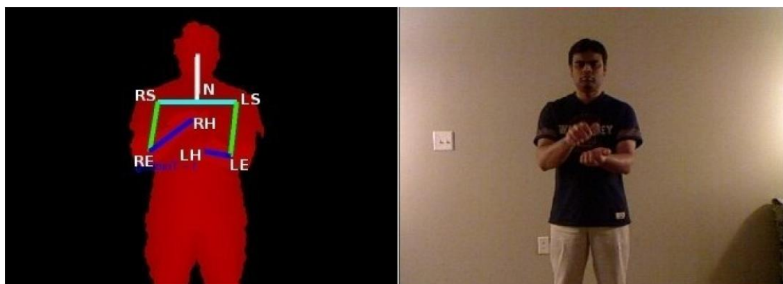
شکل ۲-۳۲- تصویری از اجرای یک اشاره در کار [۱۳] و اسکلت بدست آمده توسط سنسور کینکت. تصویر از [۱۳].
