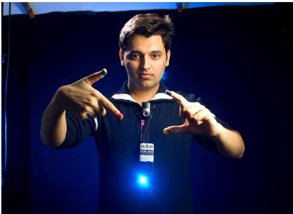
شکل ۳۱-۲- تصویری از نمونه اولیه دستگاه حس ششم و سازنده آن. نوارهای رنگی بر روی انگشتان برای تشخیص مکان دقیق انگشتان در اسکلت دست در تصویر مشخص است. تصویر از [۵۰]. ۱
