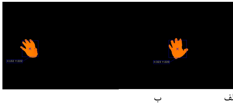
شکل ۵-۱- تصویری از فریم ابتدای (الف) و انتهایی (ب) حرکت دست به راست پس از پیش پردازش و استخراج مرکز ثقل تصویر.
