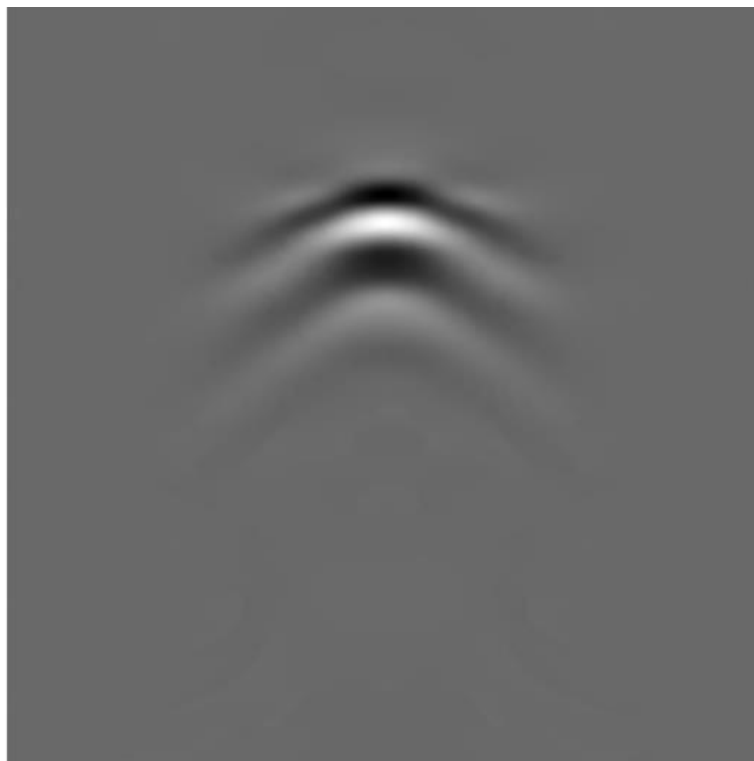
شکل ۳-۸ هدف تشخیص داده شده توسط روش MCA
