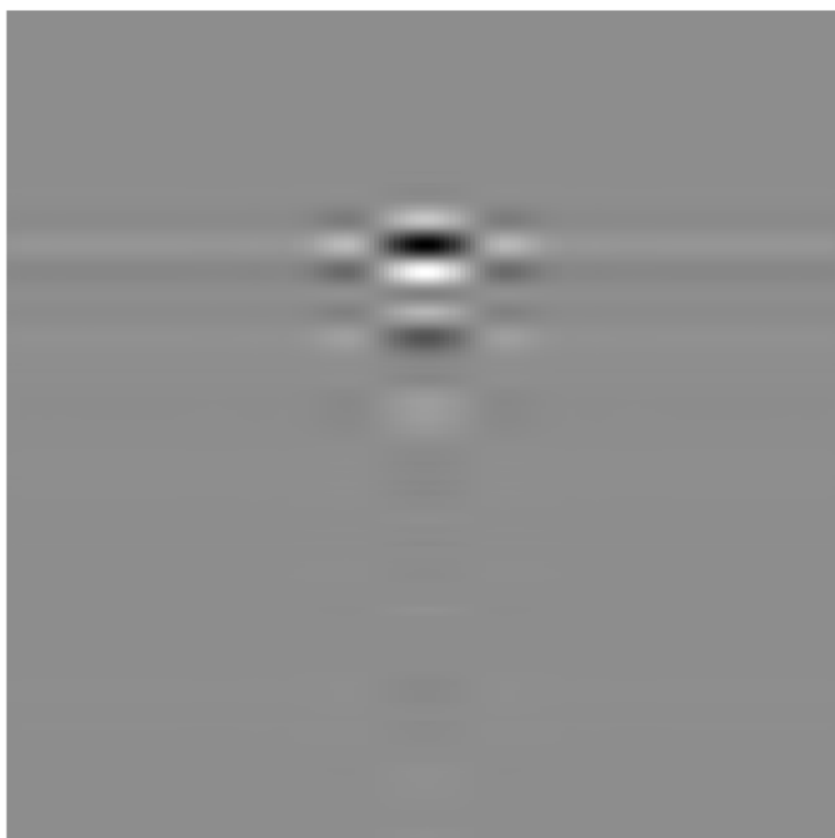
شکل ۲-۴ هدف استخراج شده از رادارگرام توسط الگوریتم FASTICA
