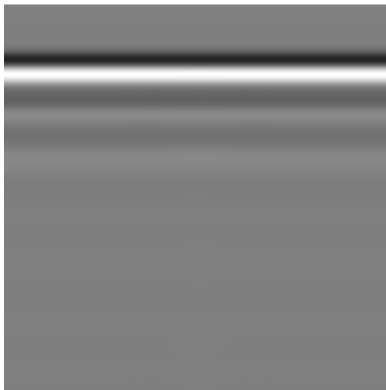
شکل ۳-۲ کلاتر تشخیص داده شده توسط روش SVD
