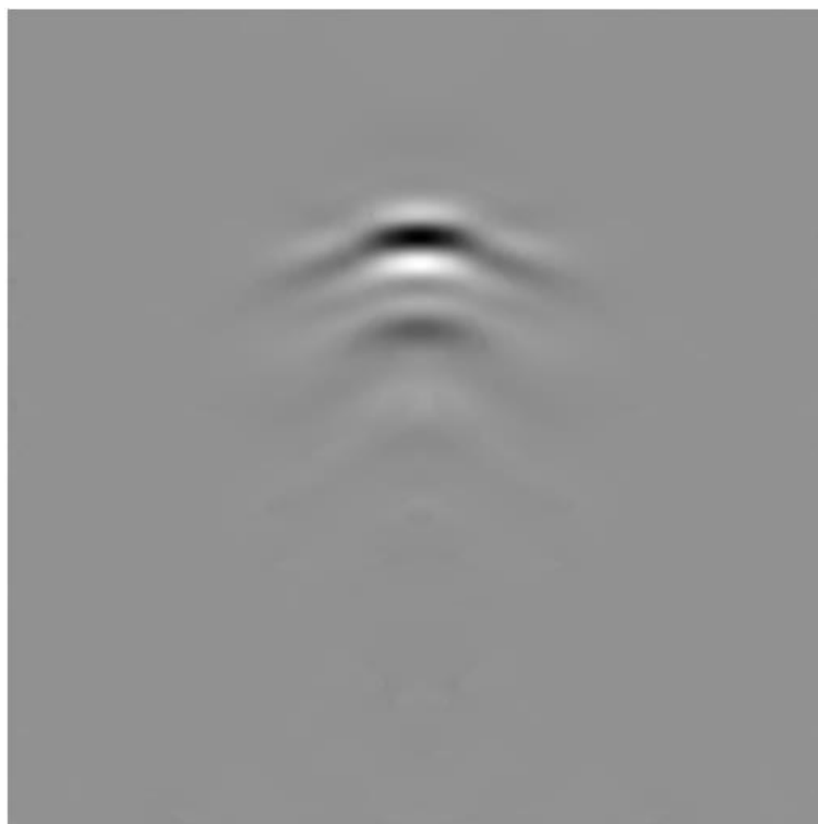
شکل ۴-۶ هدف استخراج شده از رادارگرام توسط الگوریتم MCA
