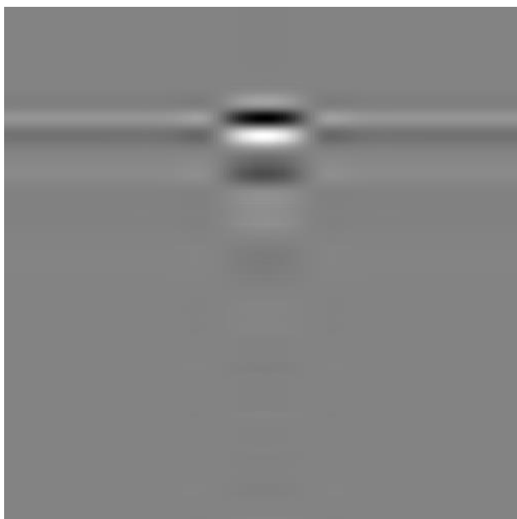
شکل ۹-۴ هدف استخراج شده از رادار گرام توسط الگوریتم PCA
