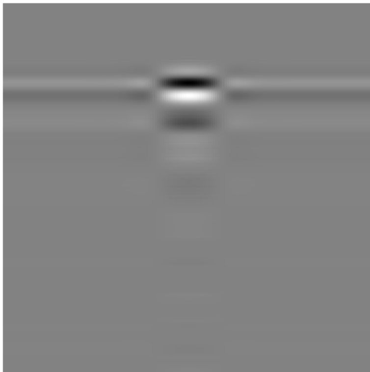
شکل ۹-۴ هدف استخراج شده از رادار گرام توسط الگوریتم PCA
