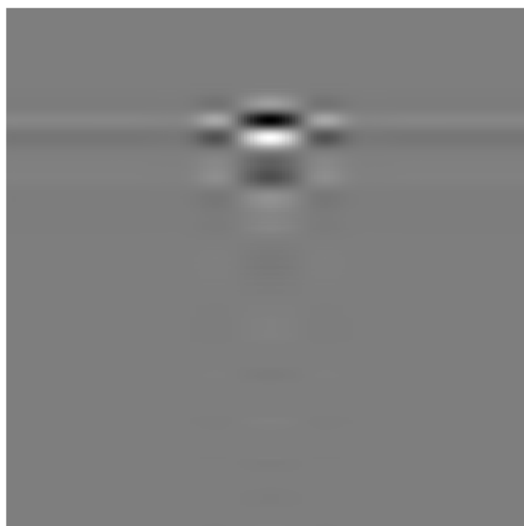
شکل ۷-۴ هدف استخراج شده از رادارگرام توسط الگوریتم FASTICA
