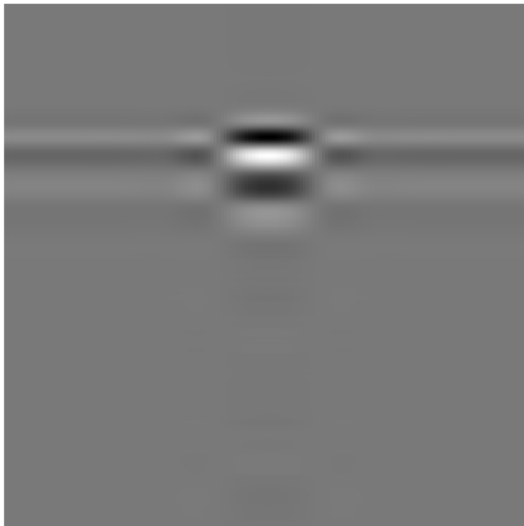
شکل ۱-۳ هدف تشخیص داده شده توسط روش SVD
