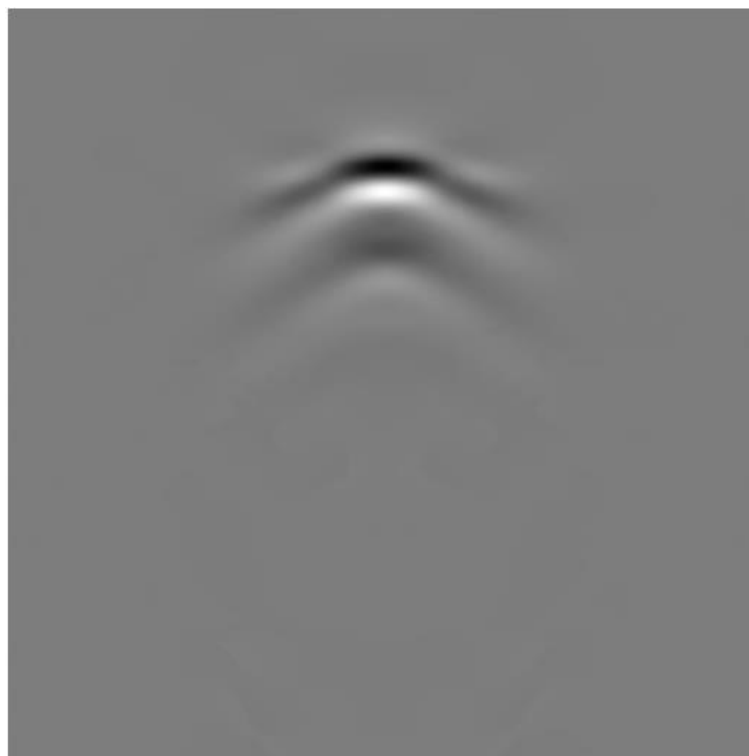
شکل ۱۱-۴ هدف استخراج شده از رادارگرام توسط الگوریتم MCA
