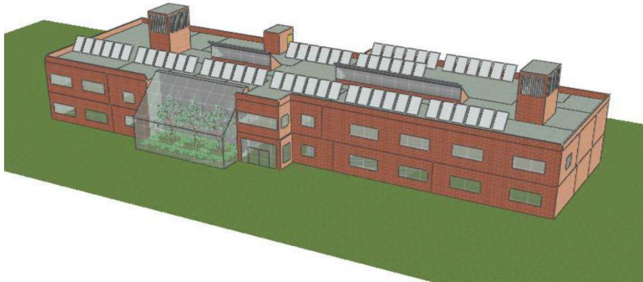
شکل ۲-۱۲- جانمایی کلکتورهای آبگرم خورشیدی بر روی ساختمان
