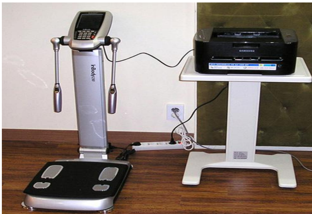
۲- ترازوی دیجیتالی برای اندازه‌گیری وزن (ساخت کشور ایران، شرکت پند، دارای ظرفیت ۱۵۰ کیلوگرم و دقت ۱۰۰ گرم می‌باشد)
