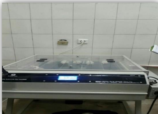
شکل ۳-۱. نوارگردان الکترونیکی حیوانی هوشمند
